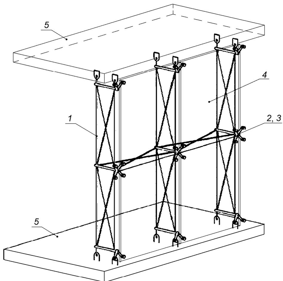
б — вантовая конструкция из стержней
