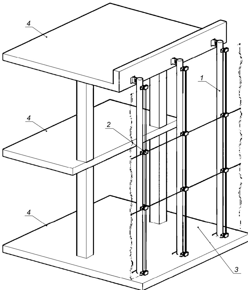
1 — каркас фахверка; 2 — зажим; 3 — заполнение; 4 — конструкции каркаса здания
