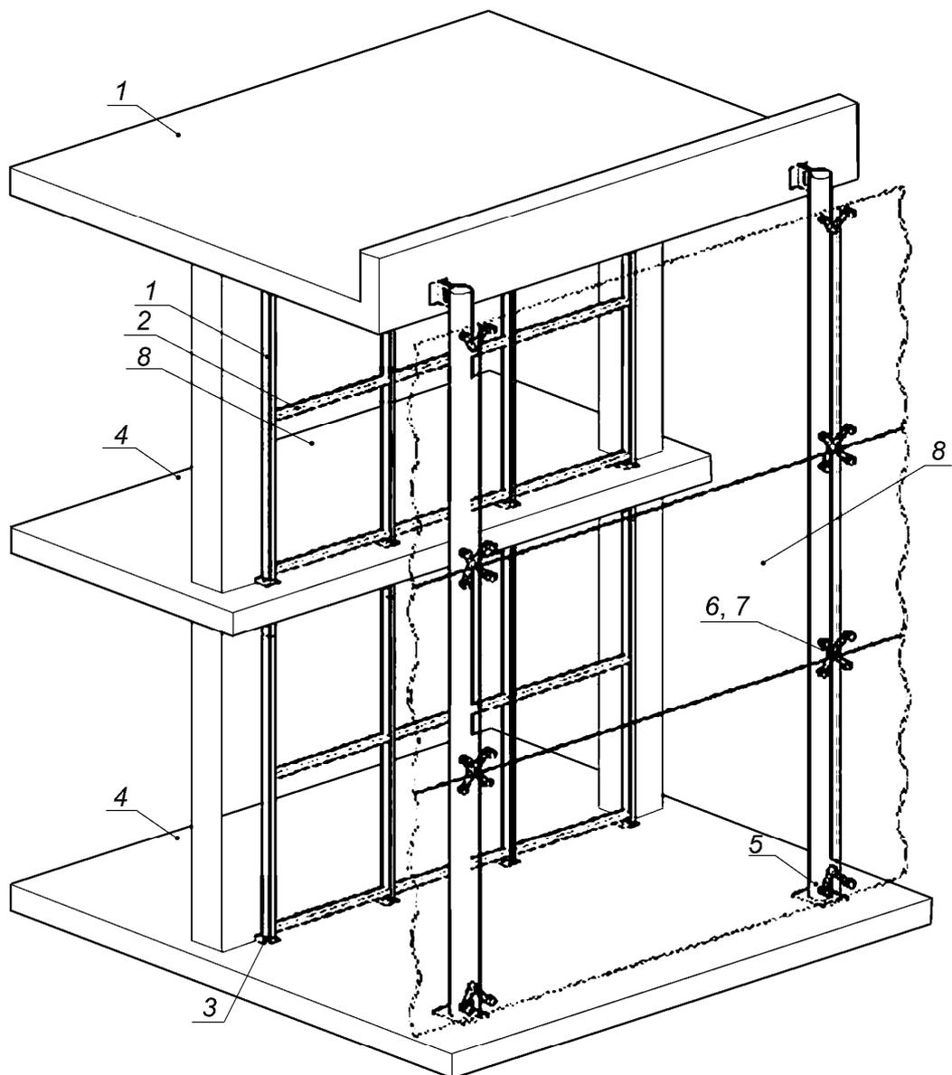
1 — стойка; 2 — ригель; 3 — кронштейн крепления; 4 — конструкции каркаса здания; 5 — каркас фахверка;
