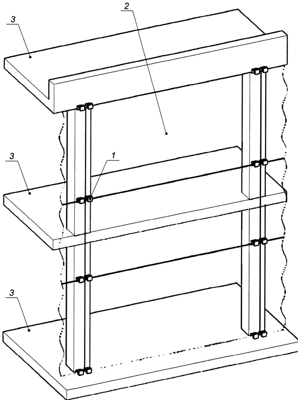
1 — зажим; 2 — заполнение; 3 — конструкции каркаса здания
