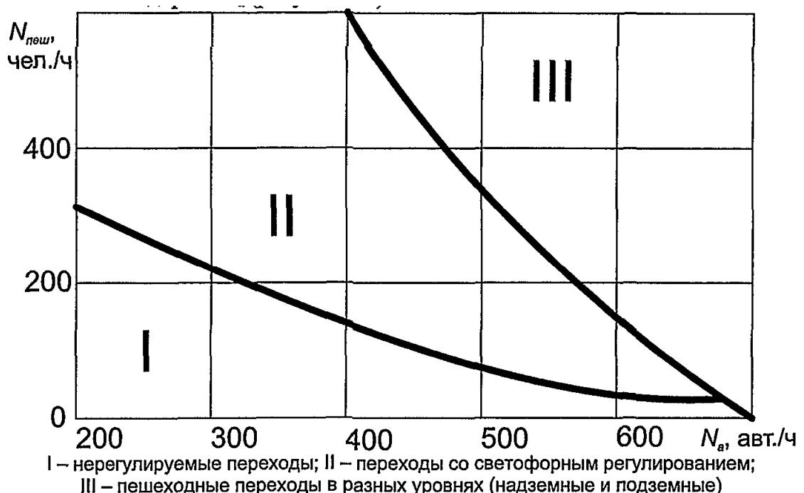
**Рисунок 6.1 – Области применения пешеходных переходов различных типов**
