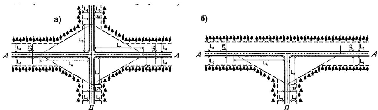
а – на пересечениях автомобильных дорог в одном уровне; б – на примыканиях автомобильных дорог в одном уровне;
