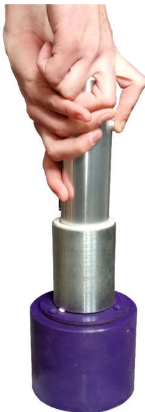
Рисунок 2.1 – Проверка молотка Шмидта на эталонной наковальне
