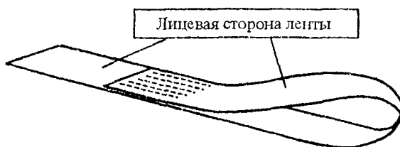
Рис. 6. Скрученная петля стропа
