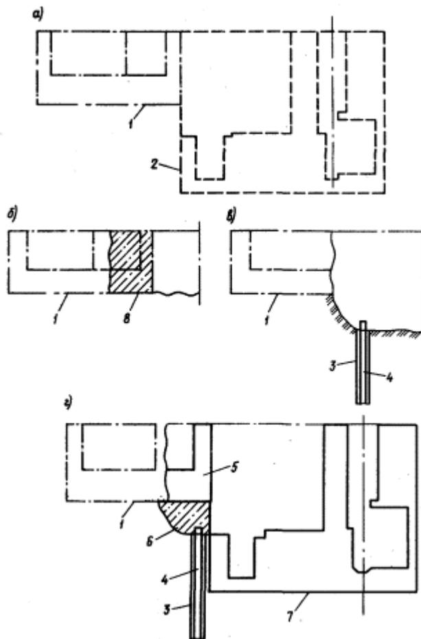
Рис. 18. Конструктивное решение при размещении фундамента с отметкой верхней поверхности ниже подошвы существующего фундамента
