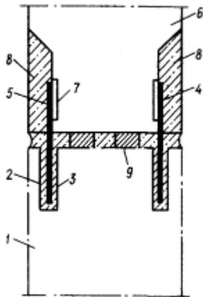
Рис. 5. Нарращивание существующей стены по высоте
