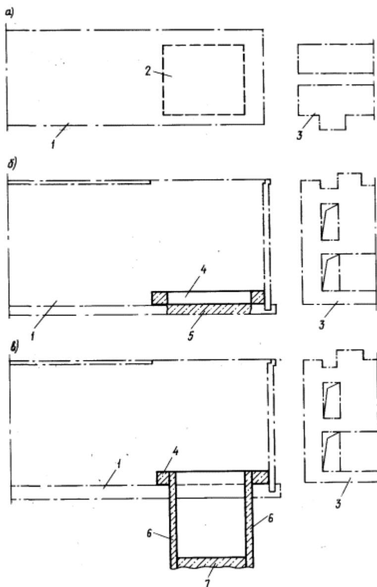
Рис. 11. Углубление существующего подвала методом подрачивания
