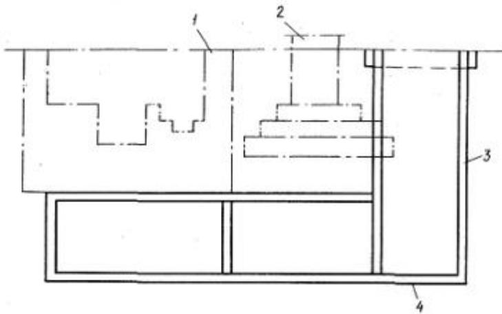
Рис. 5. Подводка тоннеля под существующий фундамент методом шахтной проходки
