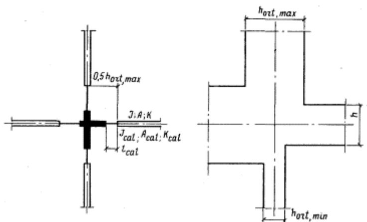
Рис. 1. Расчетная схема узла сопряжения элементов рамы
