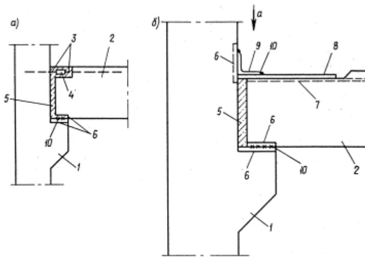
Рис. 3. Опираиie ригеля на стену или колонну
