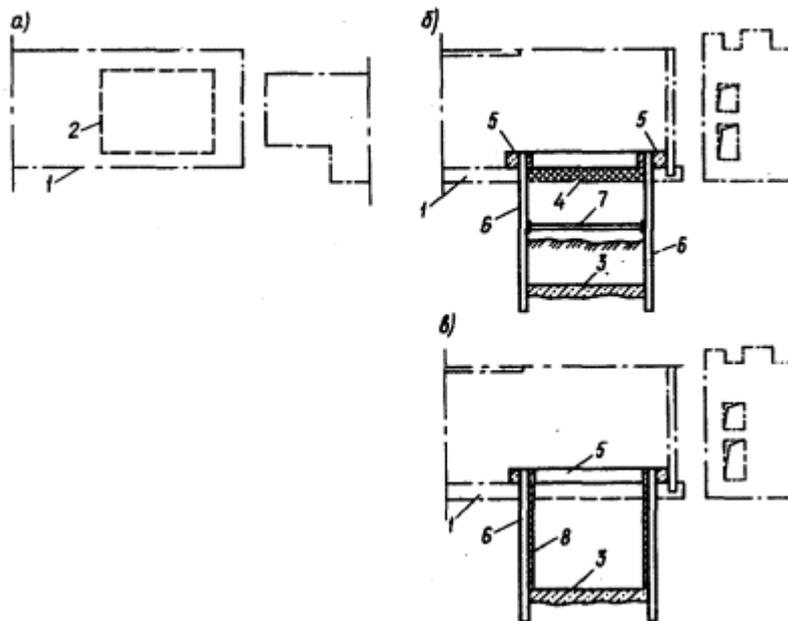
Рис. 10. Углубление подвала с применением свай
