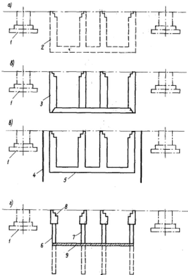
**Рис. 17. Конструктивные решения при размещении фундаментов глубокого заложения вблизи существующих фундаментов мелкого заложения**
