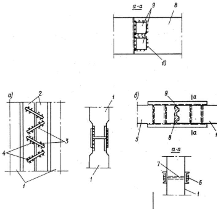
Рис. 4. Соединение элементов стены в плане
