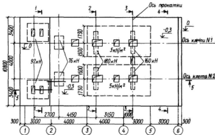
Рис. 3. Существующий фундамент. План на отметке - 5,8 м
