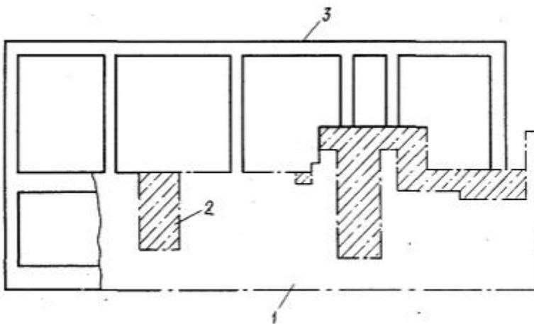
Рис. 6. Возведение на существующем фундаменте облегченных конструкций рамного типа
