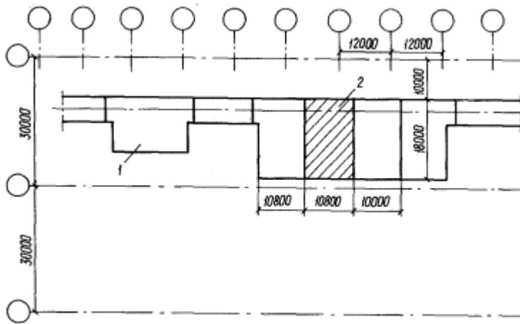
Рис. 1. Ситуационный план участка с реконструируемым фундаментом
