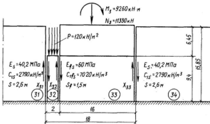
Рис. 10. Расчетная схема. Разрез I-I. II стадия расчета
