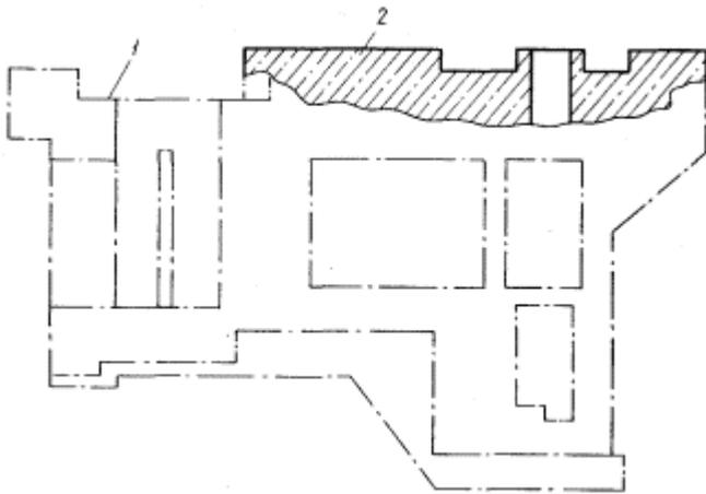
Рис. 4. Фундамент с набетонкой поверх существующего фундамента.
