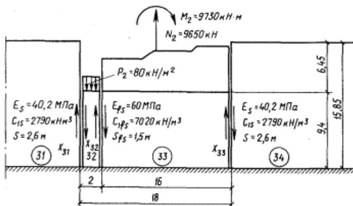
Рис. 12. Расчетная схема. Разрез I—I. III стадия расчета
