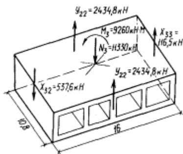
Рис. 13. Схема фундамента с приложенными внешними нагрузками и сдвиговыми силами.
