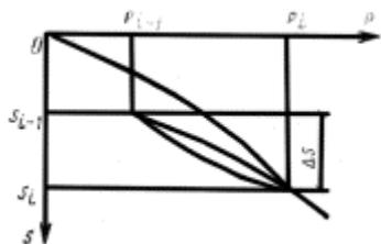
Рис. 1. График  $s=f(p)$  испытаний грунта в режиме нагрузка - разгрузка - вторичное нагружение
