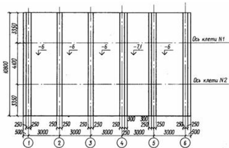
Рис. 6. Реконструируемый фундамент. План на отметку - 5,8 м
