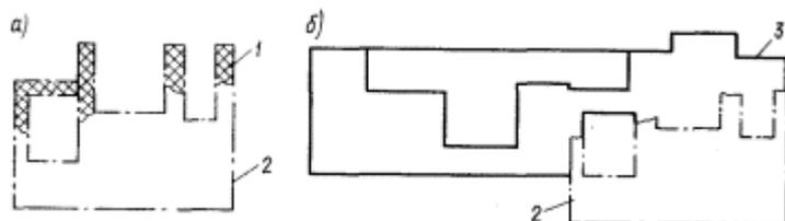
Рис. 3. Фундамент с пристроенными новыми частями
