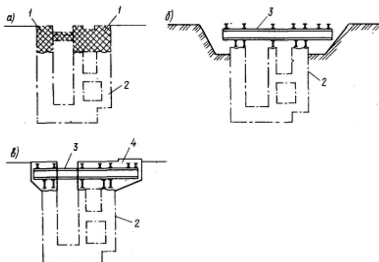
**Рис.7. Существующий фундамент с применением жестких металлических блоков**
