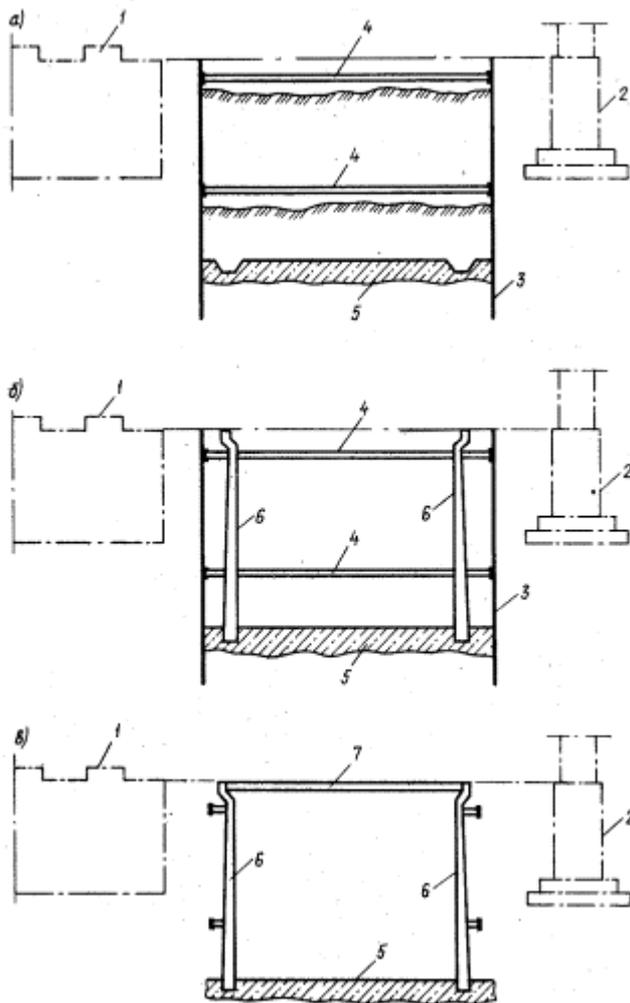
Рис. 19. Возведение подвала в существующем цеху с применением шпунтового ограждения
