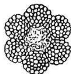
Рис.8. Уменьшение площади поперечного сечения проволок (интенсивная внутренняя
