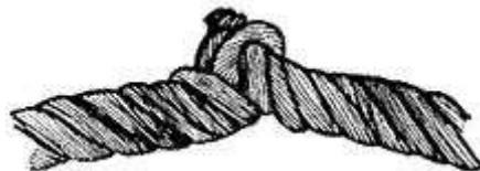
Рис.15. Перекручивание каната
