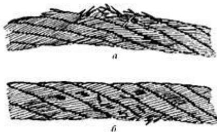
Рис.3. Обрывы проволок в зоне уравнительного блока:
