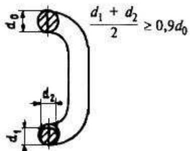
Рис.2. Уменьшение диаметра сечения звена цепи:
