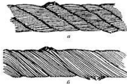
Рис. 2. Сочетание обрывов проволок с их износом:
