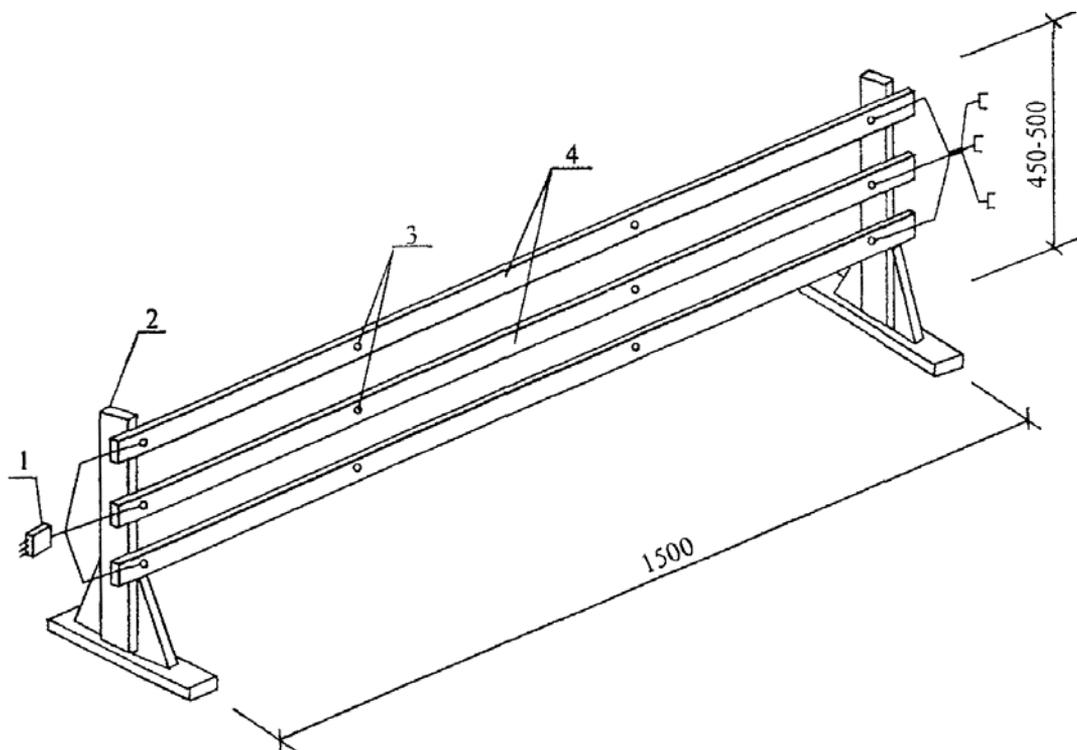
1 - разъем; 2 - деревянная стойка; 3 - болты; 4 - токопроводы (полоса 3 × 40 мм)
