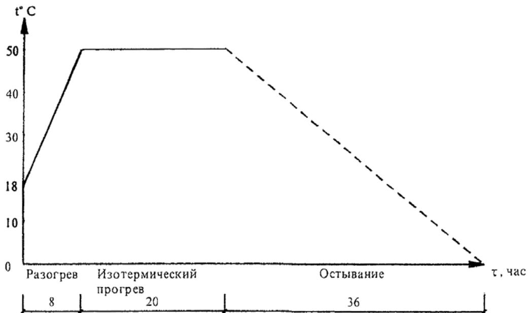
Скорость остывания бетона по окончании тепловой обработки для конструкций с модулем поверхности 5 - 10 - не более 5 °С/ч, с модулем поверхности свыше 10 - не более 10 °С/ч. Температуру наружного воздуха замеряют один-два раза в сутки, результаты замеров фиксируются в журнале.
