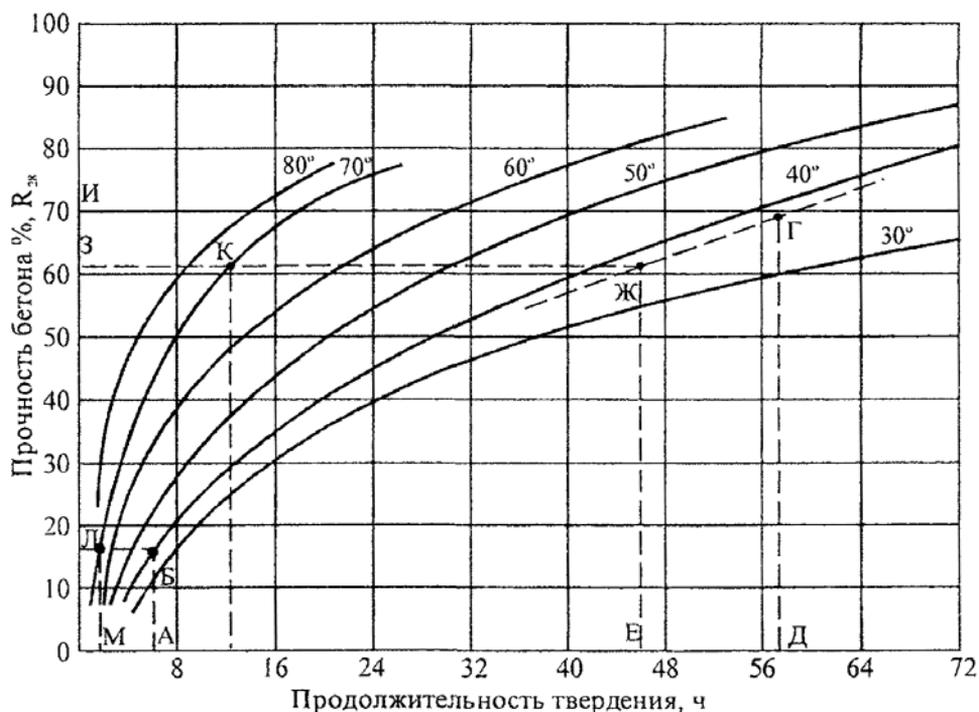
**Рисунок 7 - Пример определения прочности бетона по графику**
