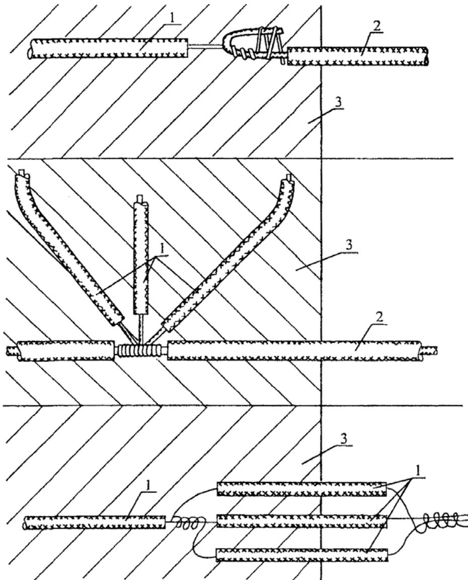
1 - нагревательные провода; 2 - монтажные провода; 3 - бетон
