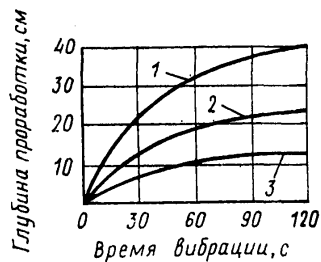
Рисунок 1.9 — Влияние продолжительности вибрирования смеси поверхностным вибратором на глубину ее уплотнения при осадке конуса:
