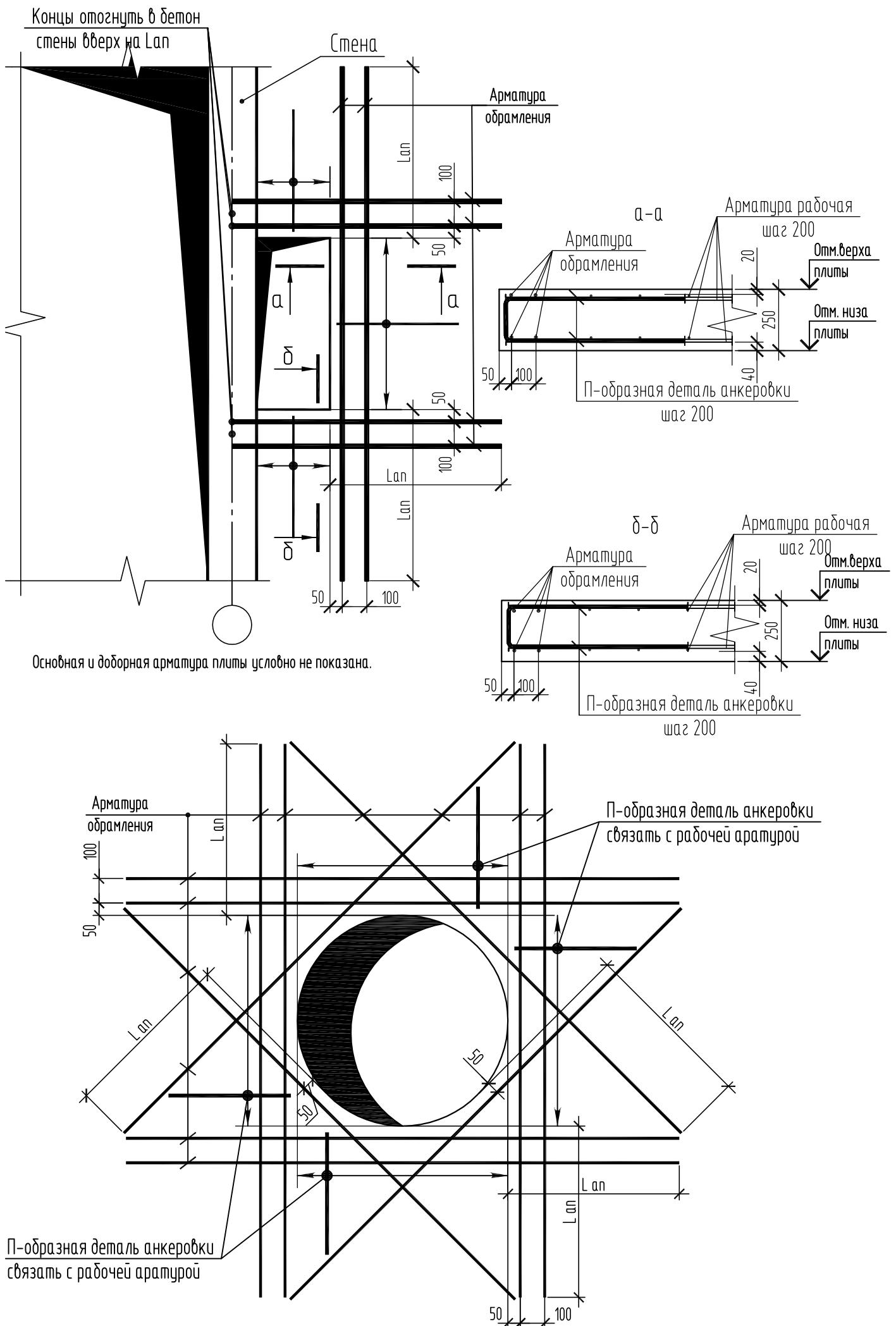
Чузел устройства консольного примыкания плиты перекрытия к стене
