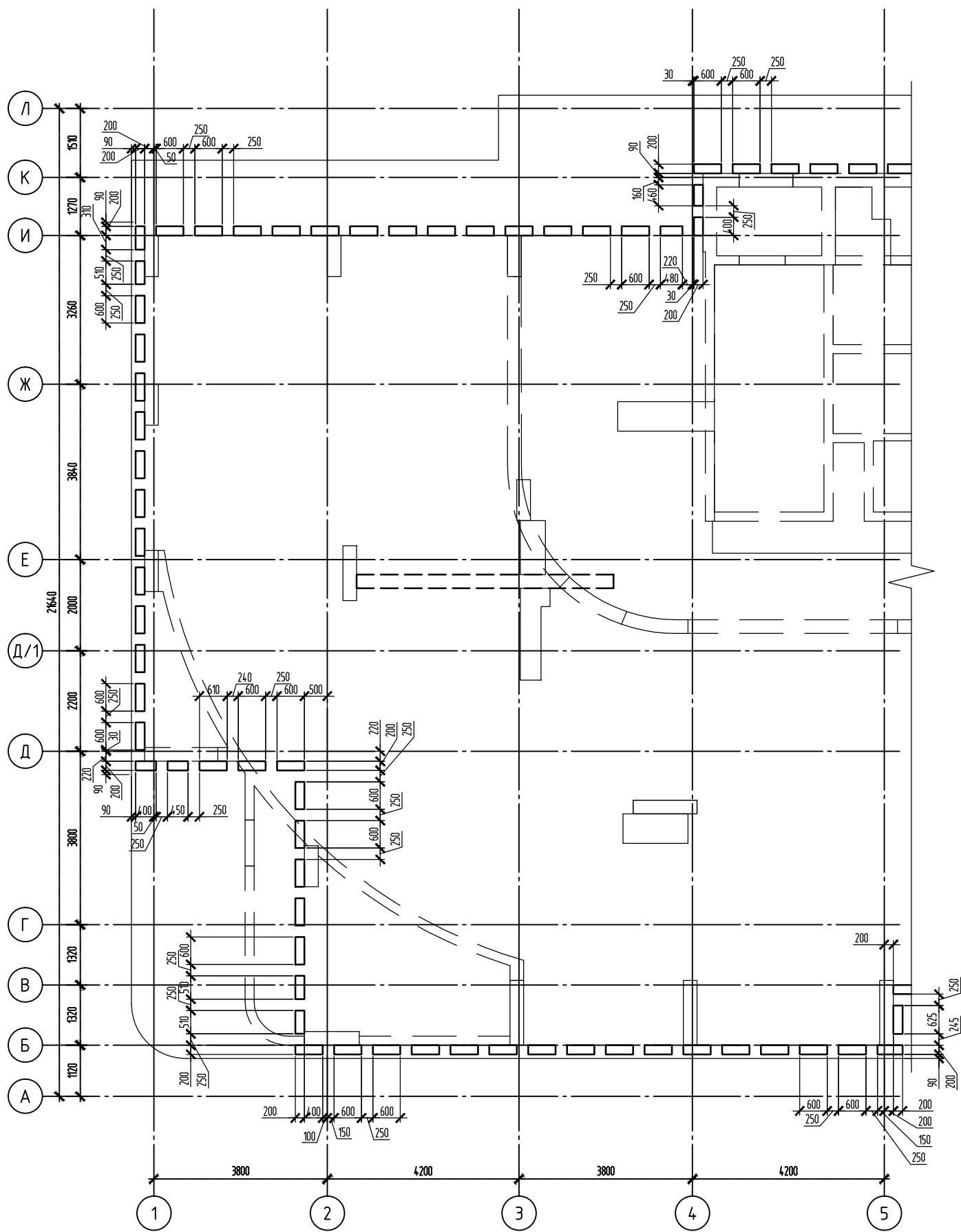
Фрагмент плиты перекрытия. Нижнее армирование.
