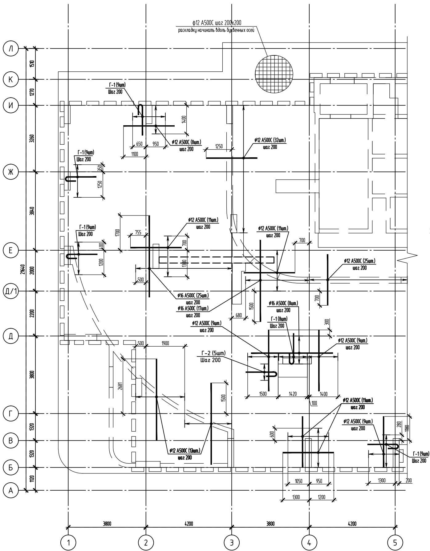
Детали армирования плиты перекрытия. Сечения 1-1, 2-2, 2\*-2\*.
