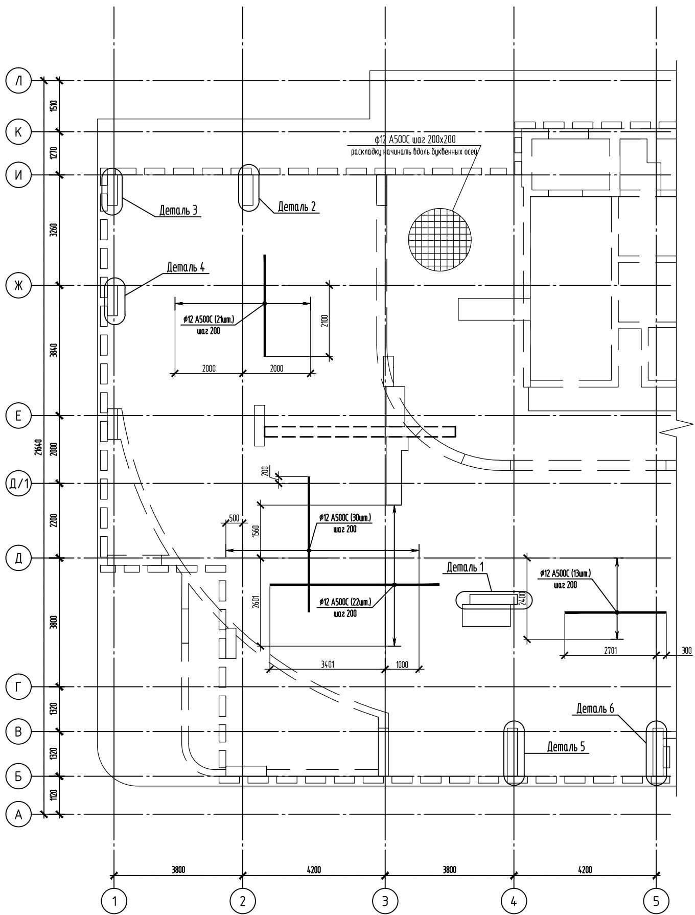
Фрагмент плиты перекрытия. Верхнее армирование.
