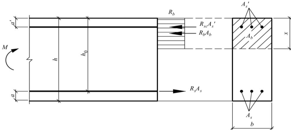
Рисунок 2.3 – Схема усилий и эпюра напряжений в сечении, нормальном к продольной оси изгибающего железобетонного элемента, при его расчете по прочности
