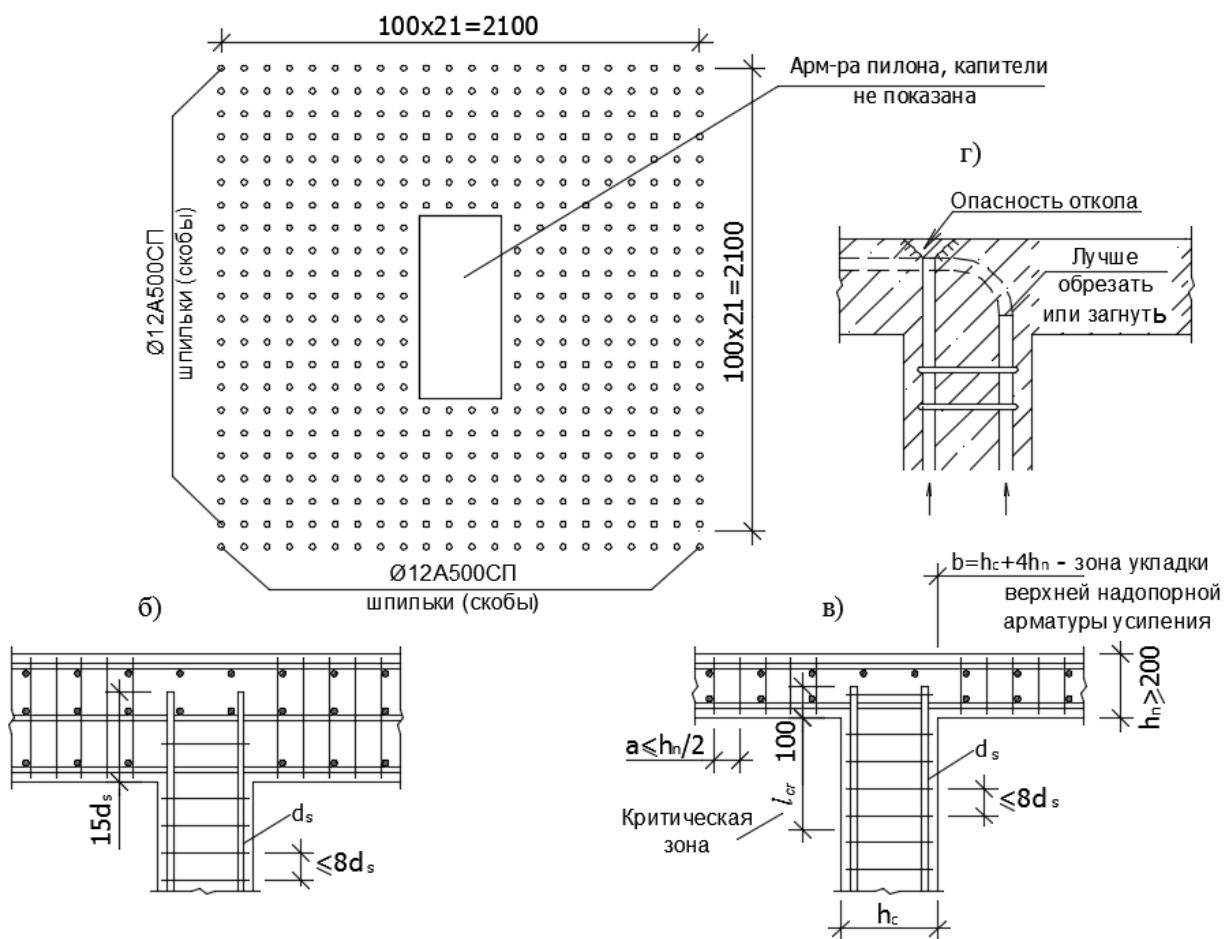
Рисунок 3.8 – Схемы армирования участков опирания плит перекрытий (покрытий) на колонны (пилоны): *a, б* – с капителями; *в* – без капителей; *г* – окончание сжатых стержней близ свободной поверхности бетона
