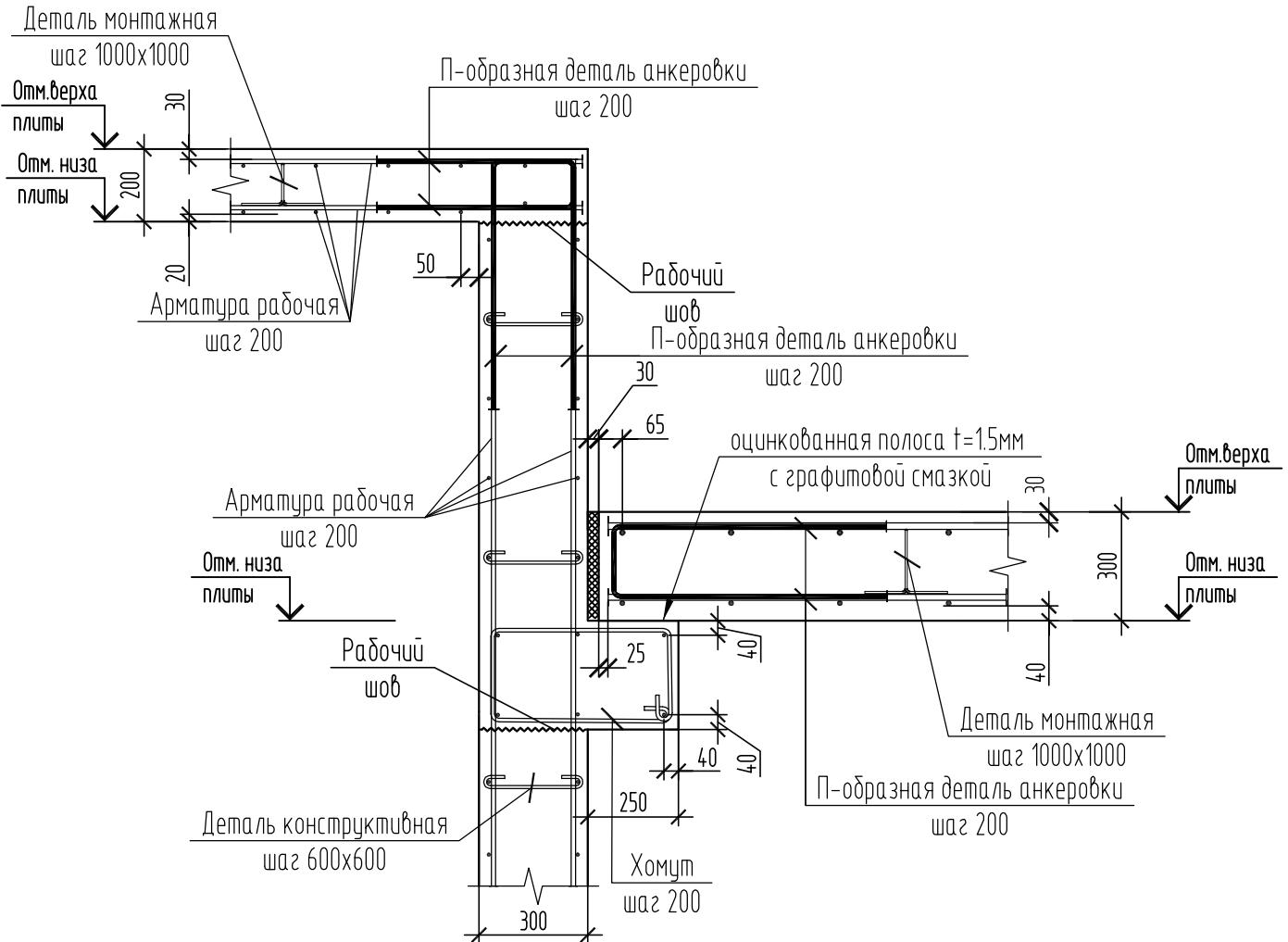
Чзел устройства консольного примыкания плиты перекрытия к плитам перекрытия
