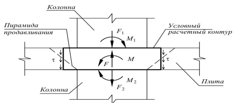
Рисунок 2.6 – Условная модель для расчета на продавливание
