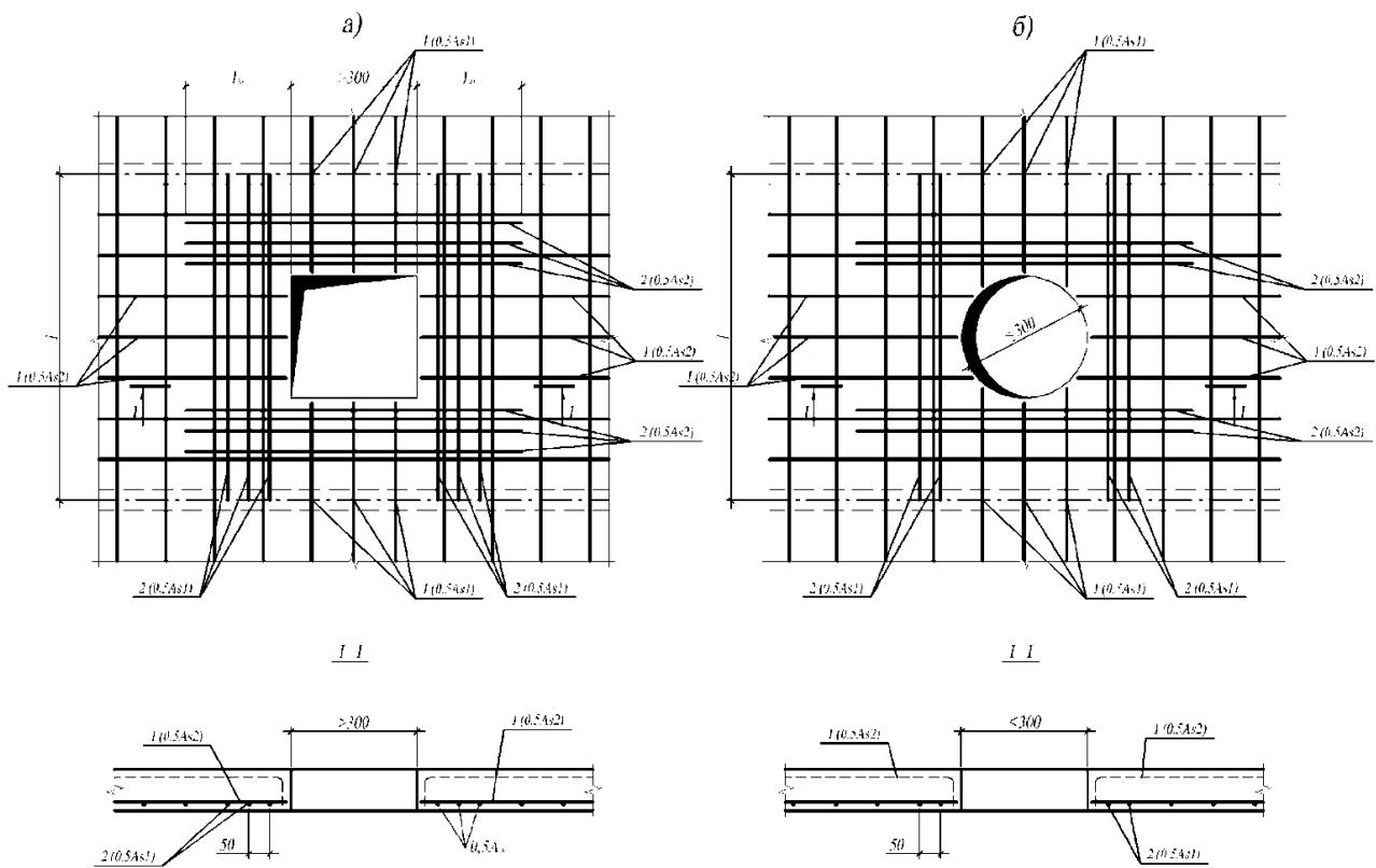
Рисунок 3.9 – Армирование плит в местах отверстий:
