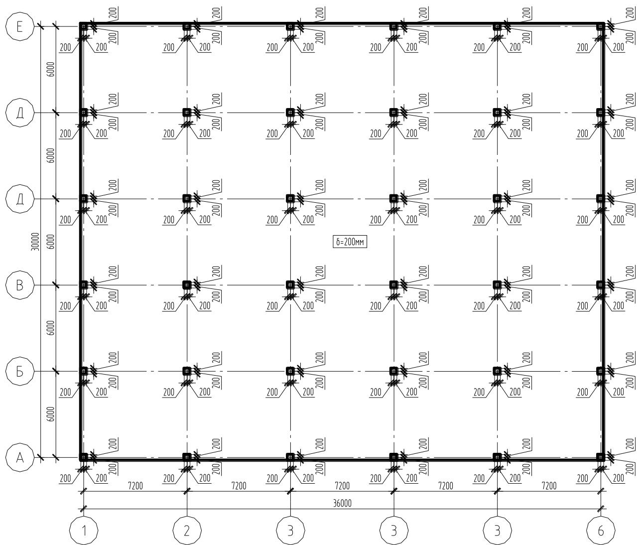
Рисунок П1 – Схема расположения вертикальных и горизонтальных несущих элементов каркаса
