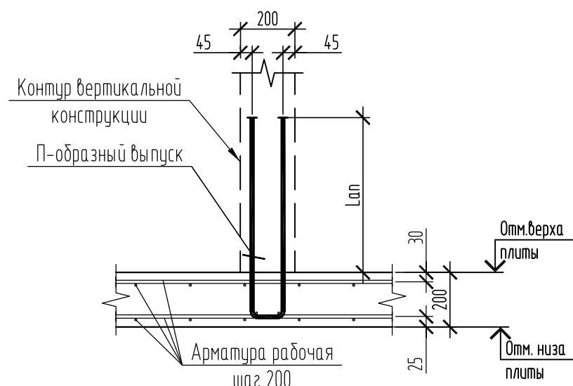
Фрагмент плиты перекрытия. Опалубка.
