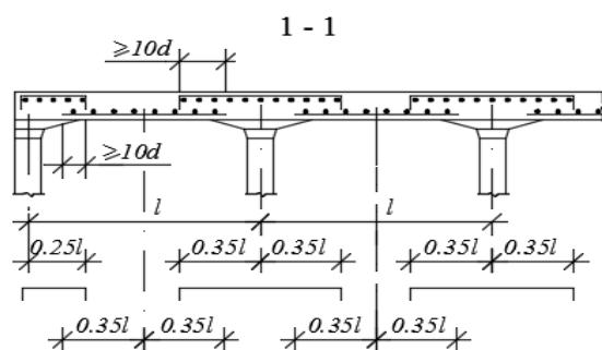
Рисунок 3.7 – Схемы армирования безбалочных перекрытий с пирамидальными надколонными капителями:
