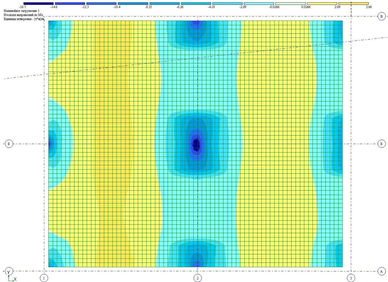
Рисунок П12 – Изополя изгибающих моментов  $M_x$  (вдоль пролета 7,2 м) от действия полных расчетных нагрузок,
