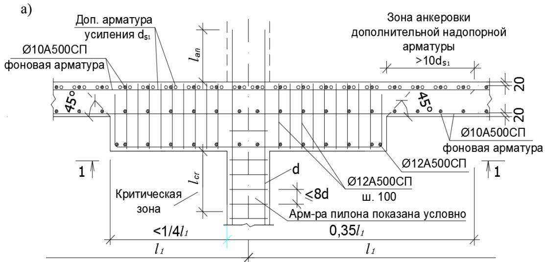
**1 - 1 (Схема установки поперечной арматуры)**
