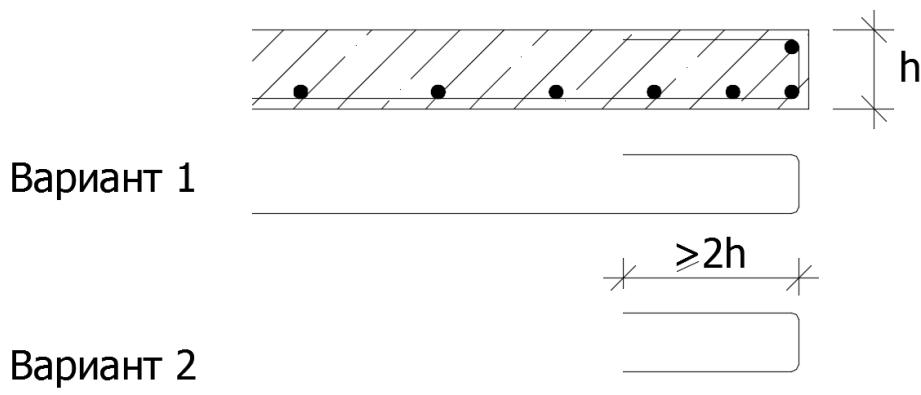
Рисунок 3.10 – Дополнительная краевая арматура плит
