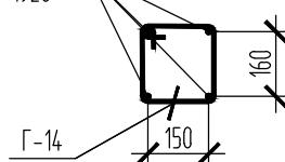
Деталь раскладки каркасов на продавливание. Детали 1, 2.
