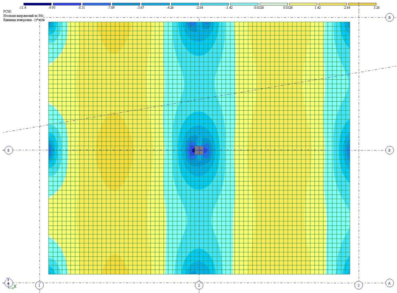
Рисунок П3 – Изополя изгибающих моментов  $M_x$  от полных расчетных нагрузок
