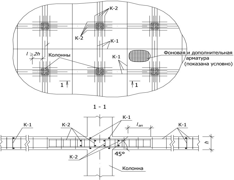
Рисунок 3.1 – Принципиальная схема расположения арматуры плиты перекрытия
