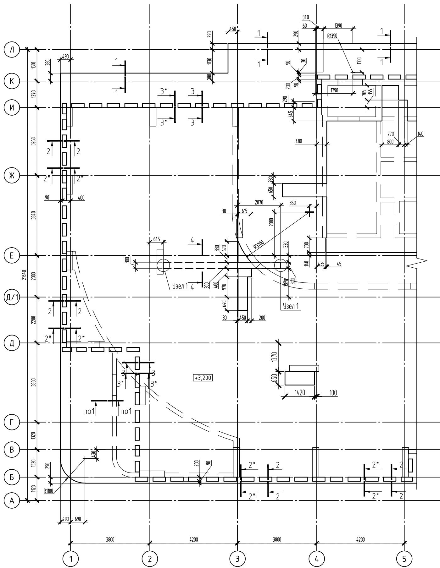
Фрагмент плиты перекрытия. Схема расположения термокладышей.
