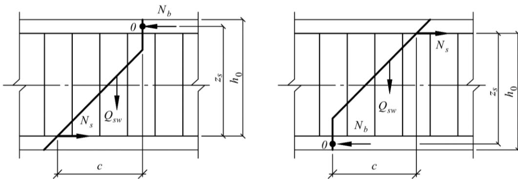
Рисунок 2.5 – Схема усилий при расчете железобетонных элементов по наклонному сечению на действие моментов
