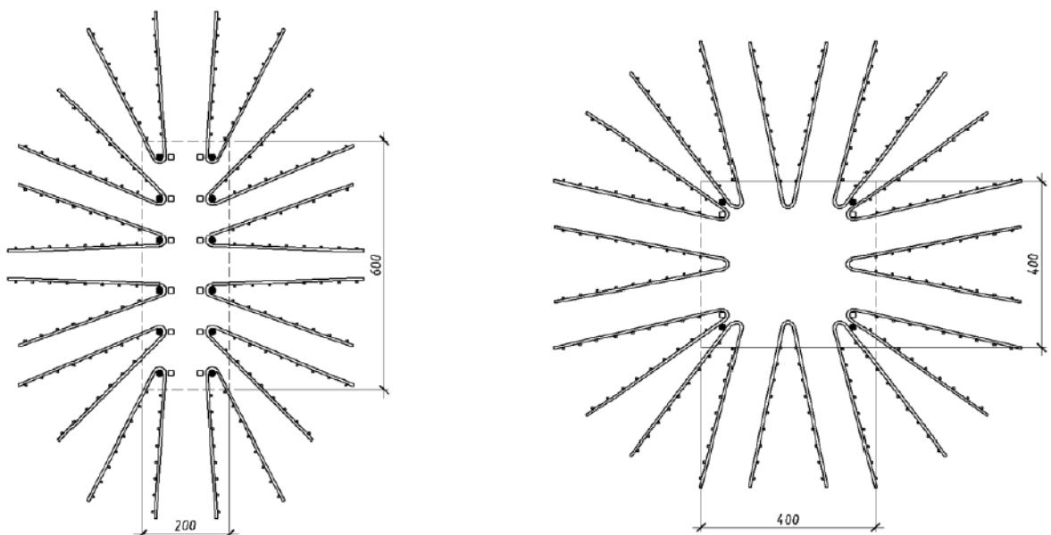
Рисунок 3.3 – Схемы расстановки изогнутых каркасов
