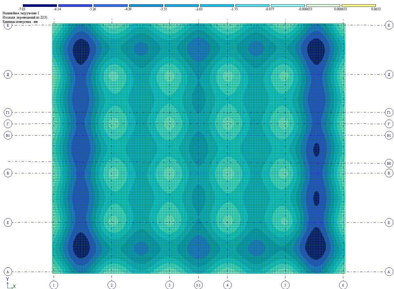
Рисунок П13 – Мозаика вертикальных перемещений от действия длительных
