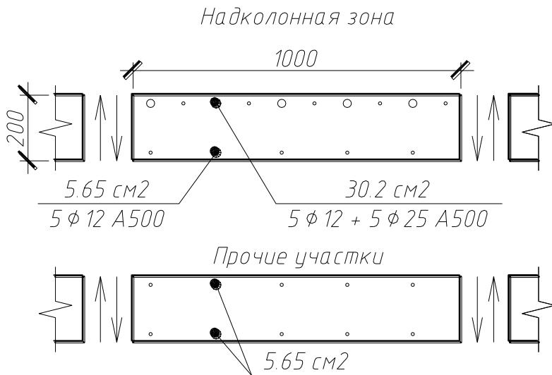
Равнодействующую растянутой арматуры определим через фактическое содержание арматуры при A500,  $R_{s,n} = R_{s,ser} = 400 \text{ МПа}$ ;
