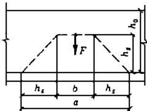
Рисунок 2.10 – Схема для расчета железобетонных элементов на отрыв
