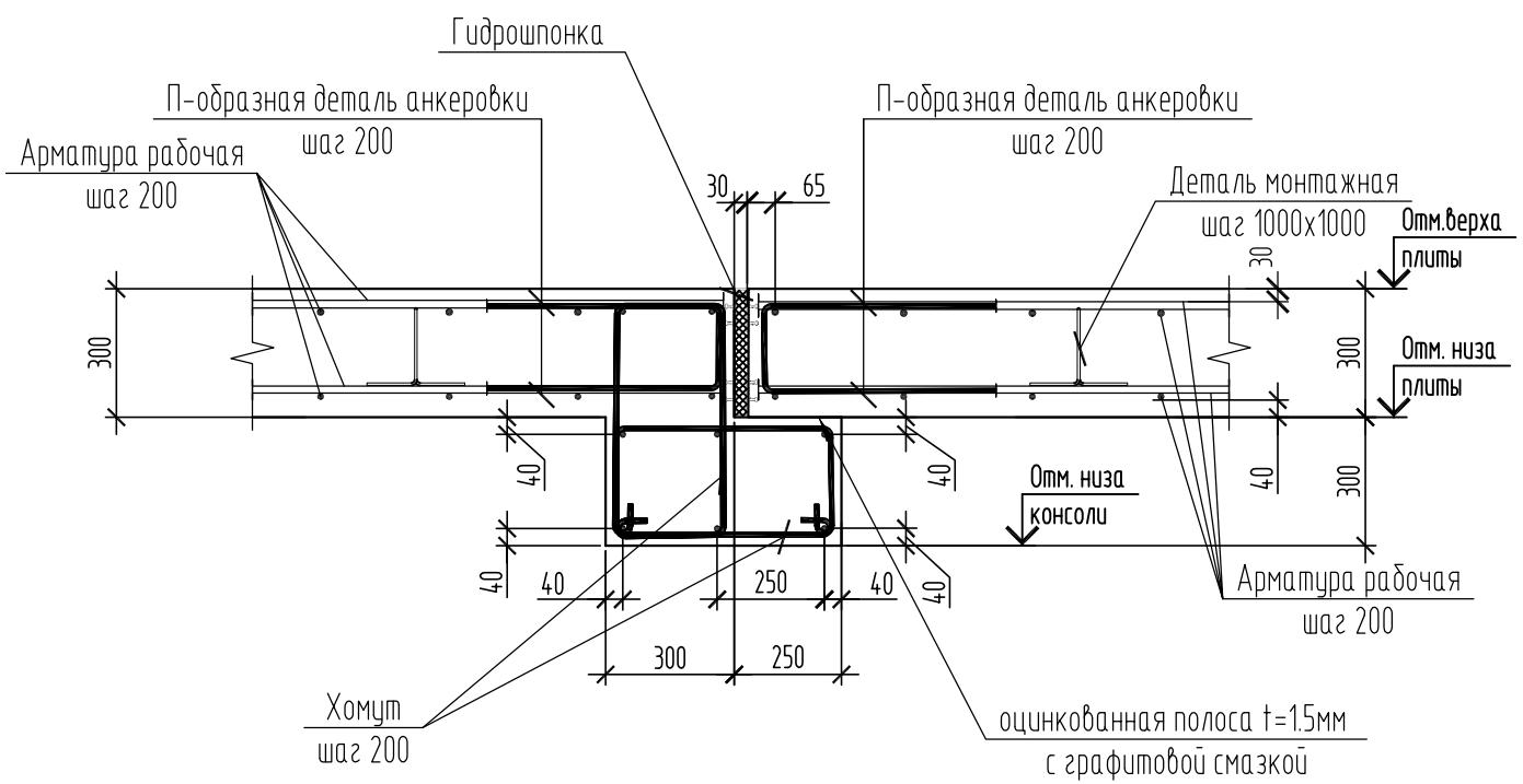
Деталь раскладки каркасов на продавливание
