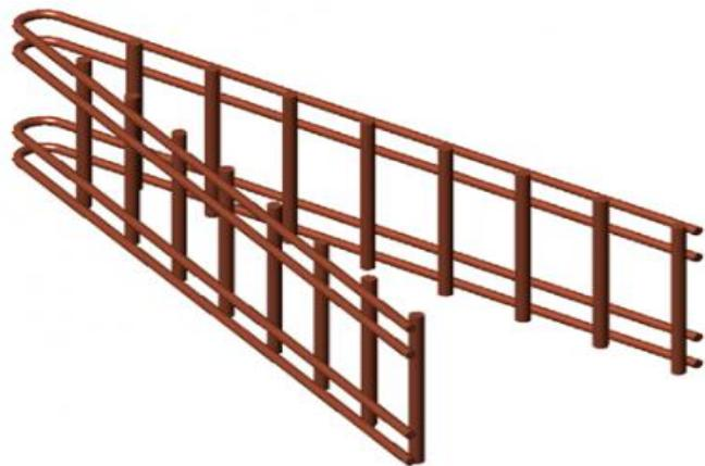
Рисунок 3.2 – Изогнутый каркас для предотвращения продавливания плит
