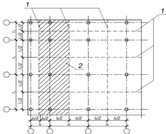
Рисунок 2.1 – Разделение каркаса на заменяющие рамы:
