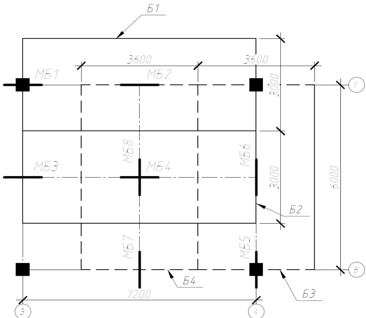
Рисунок П14. Разрезка плиты на заменяющие рамы
