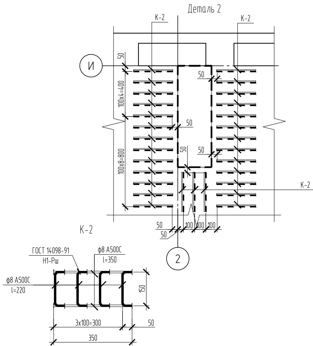
Деталь раскладки каркасов на продаевание. Деталь , Детали 3, 4, 5, 6.
