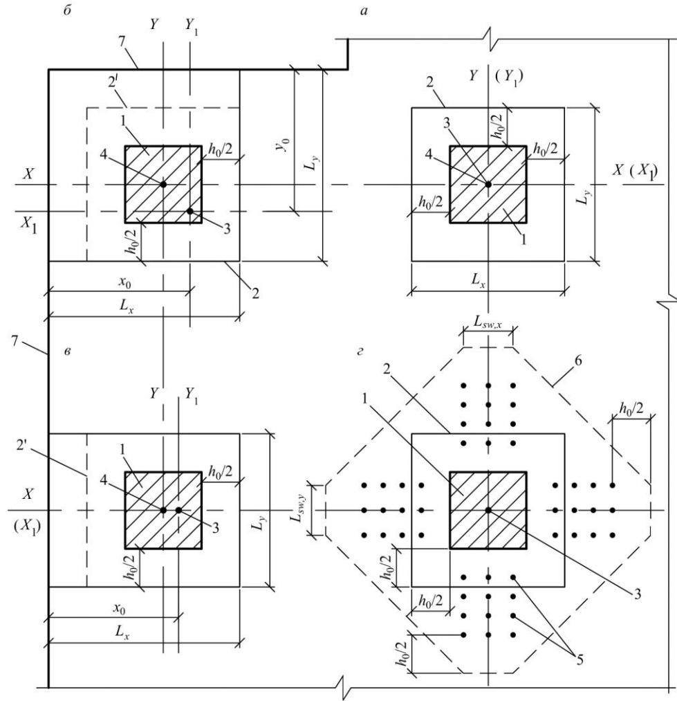
Рисунок 2.7 – Схема расчетных контуров поперечного сечения при продавливании:
