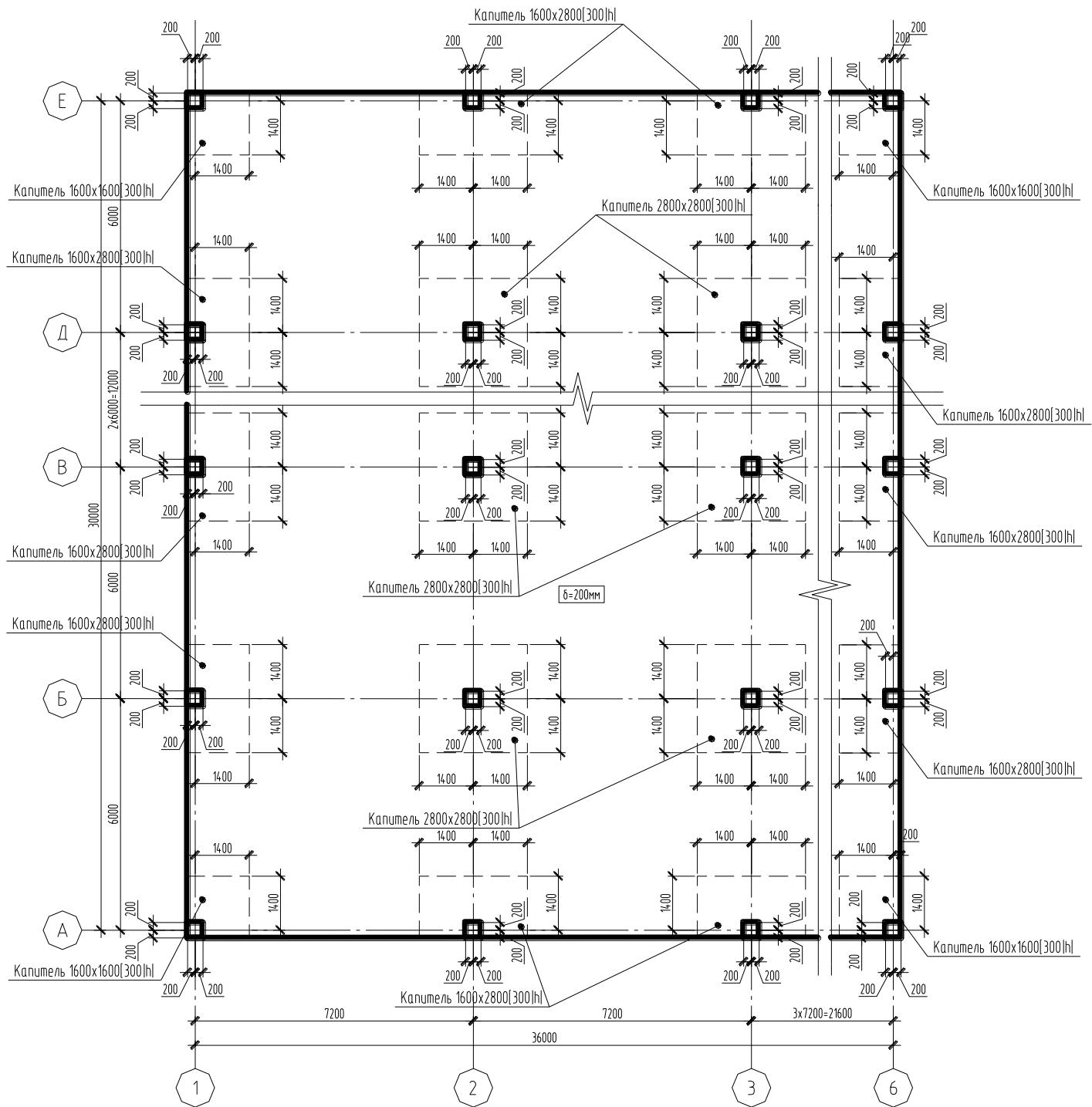
Рисунок П4 – Схема каркаса с капителями
