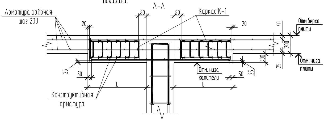
Деталь устройства каркасов на продавливание без капители
