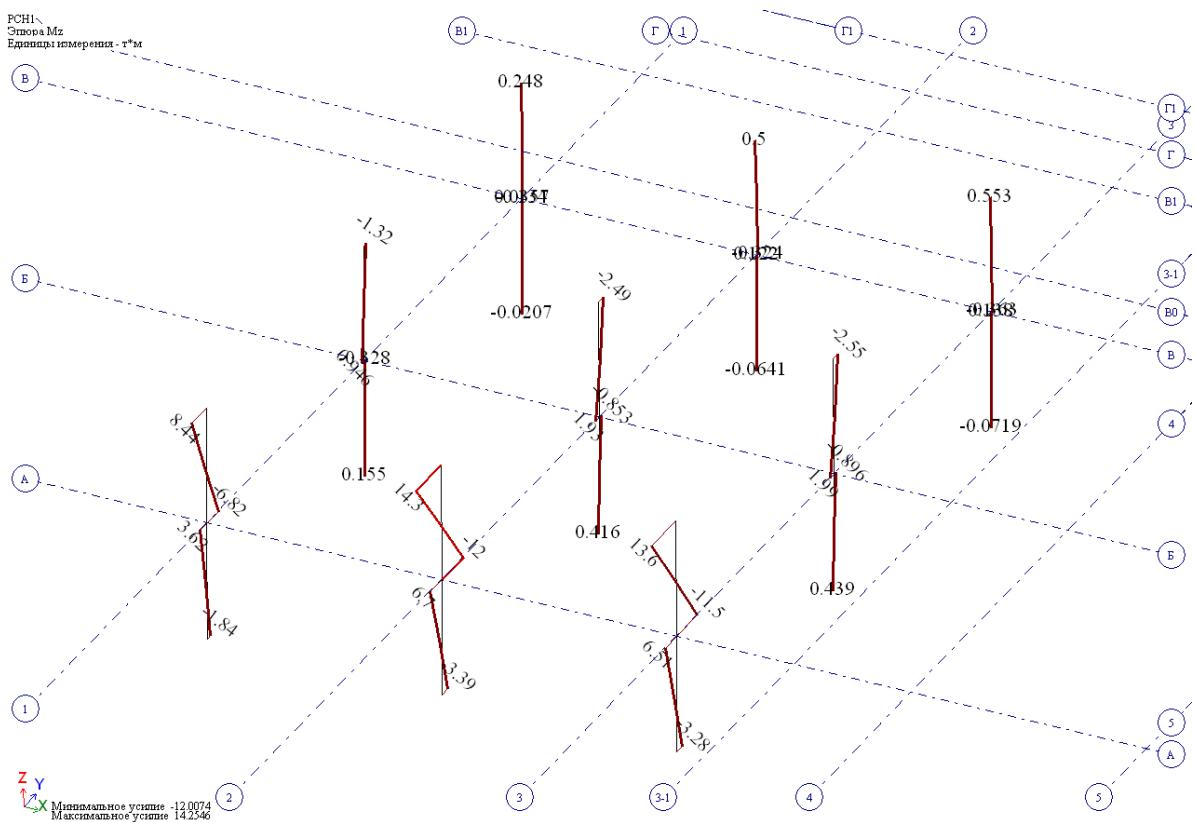
Рисунок П9 – Эпюры изгибающих моментов  $M_z$  от действия полных расчетных нагрузок.
