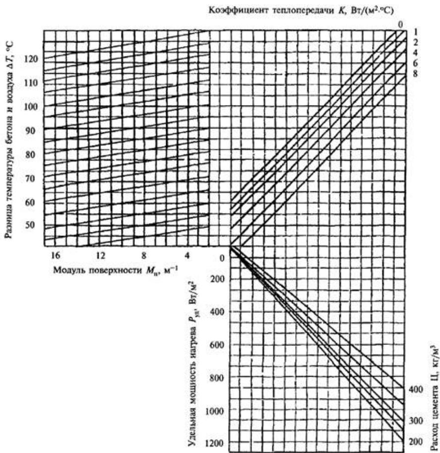
**Рисунок 1 - Номограмма для определения удельной мощности нагрева бетона**
