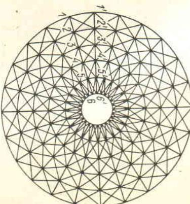
Рис. 59. Схема сетчатого купола
