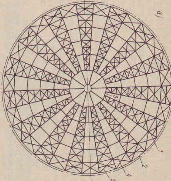
**Купольное покрытие над корпусом склада глиноzemного завода Карагайлинского горнодобывающего комбината** (рис. 31) представляет собой ребристо-кольцевой купол; диаметр его 56, 64 м., стрела подъема 10 м. Двадцать восьмь ребер двутаврового сечения опираются внизу на опорное кольцо и в ключе на верхнее кольцо двутаврового сечения.
