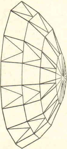
Рис. 33. Схема ребристо-кольцевого купола со сферической решеткой через сектор
