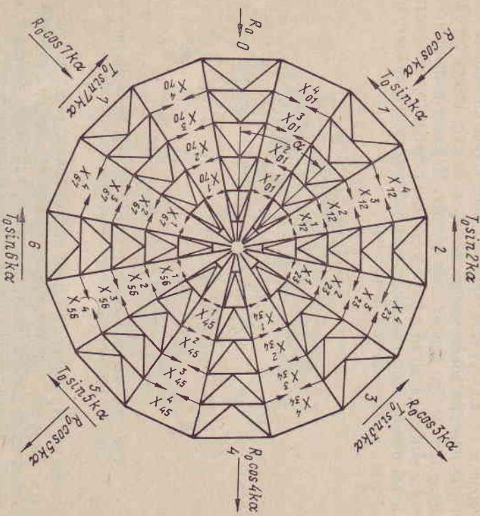
Рис. 34. Основная система купола с указанием лишних неизвестных усилий в перезаданных кольцах и внешней нагрузки по первому члену разложения
