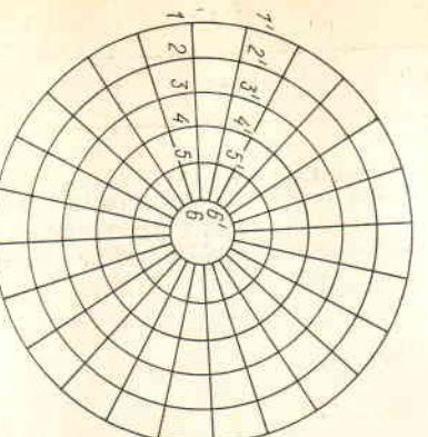
Рис. 58. Схема ребристо-кольцевого купола
