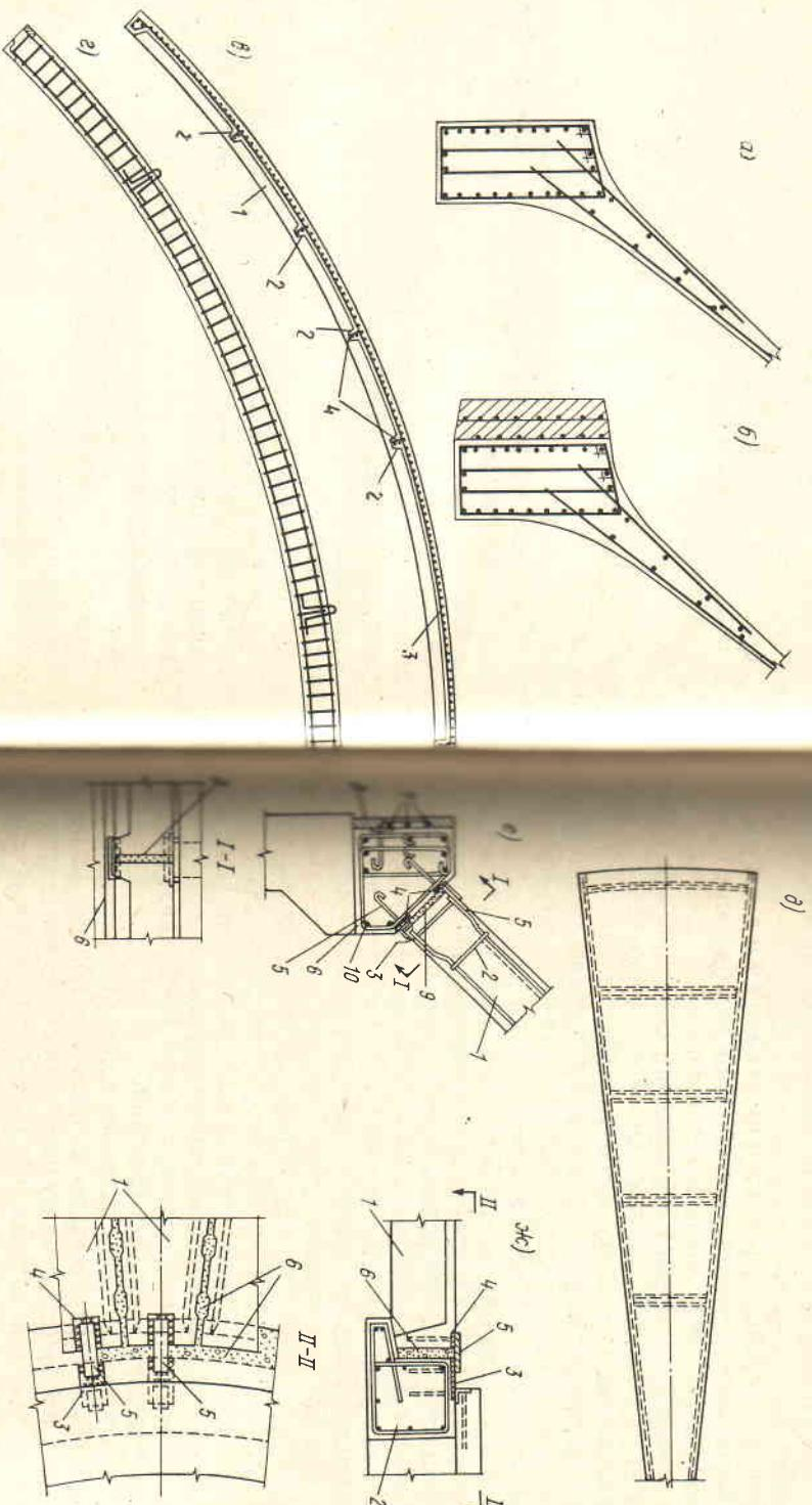
Рис. 14. Детали армирования монолитных
