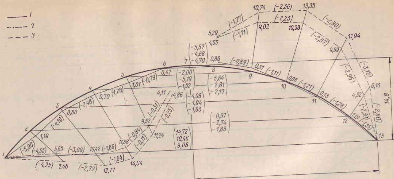
Рис. 61. Эпюра изгибающих моментов и нормальных сил в наиболее загруженной арке при односторонней снеговой загрузке (в скобках даны значения нормальных сил)
