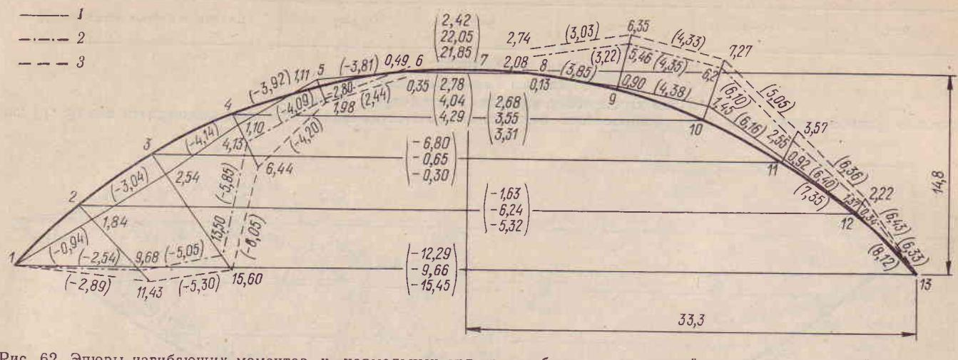
Рис. 62. Эпюры изгибающих моментов и нормальных сил в наиболее загруженной арке при ветровой нагрузке (в скобках даны значения нормальных сил)
