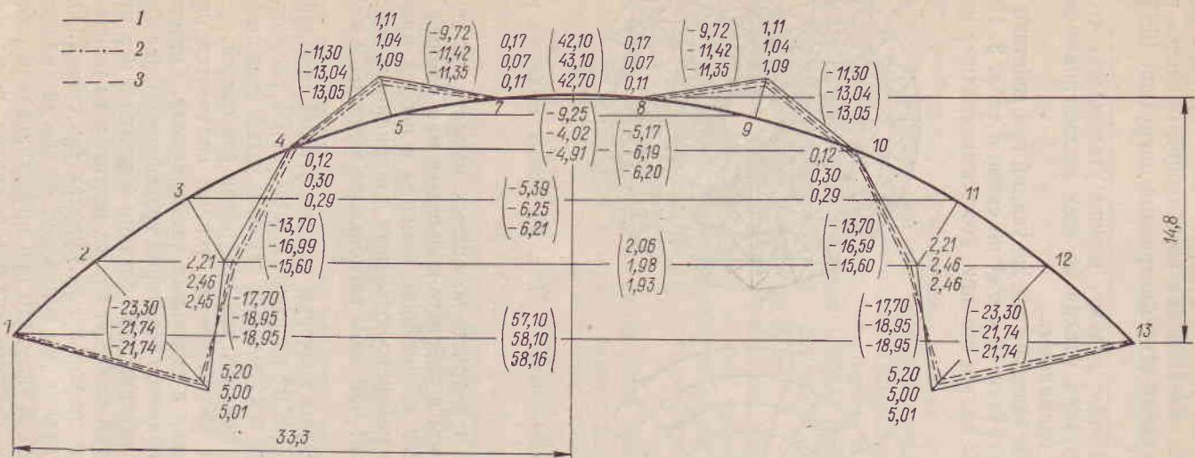
Рис. 60. Эпюра изгибающих моментов и нормальных сил в куполе при загружении осесимметричной нагрузкой (в скобках даны значения нормальных сил)
