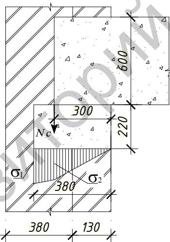
Рис. 3.3. К определению напряжений на опоре
