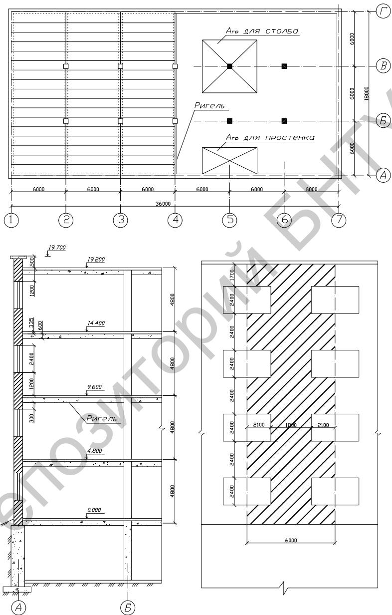
Рис. 1.1. План, разрез и фрагмент фасада здания
