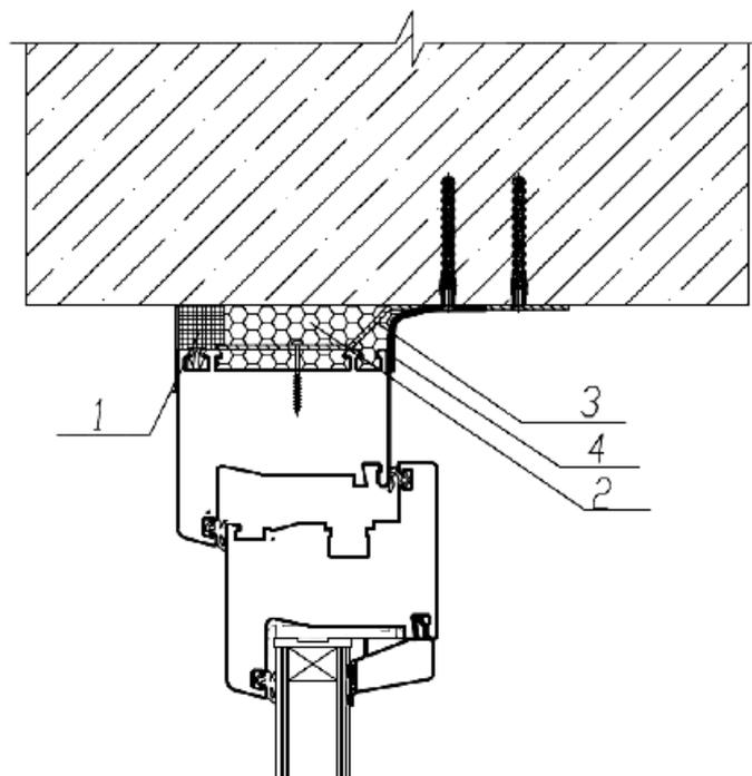
1 - изоляционная саморасширяющаяся паропроницаемая лента (ПСУЛ) с нащельником из ПВХ; 2 - пенный утеплитель; 3 - анкерная пластина; 4 - пароизоляционная лента
