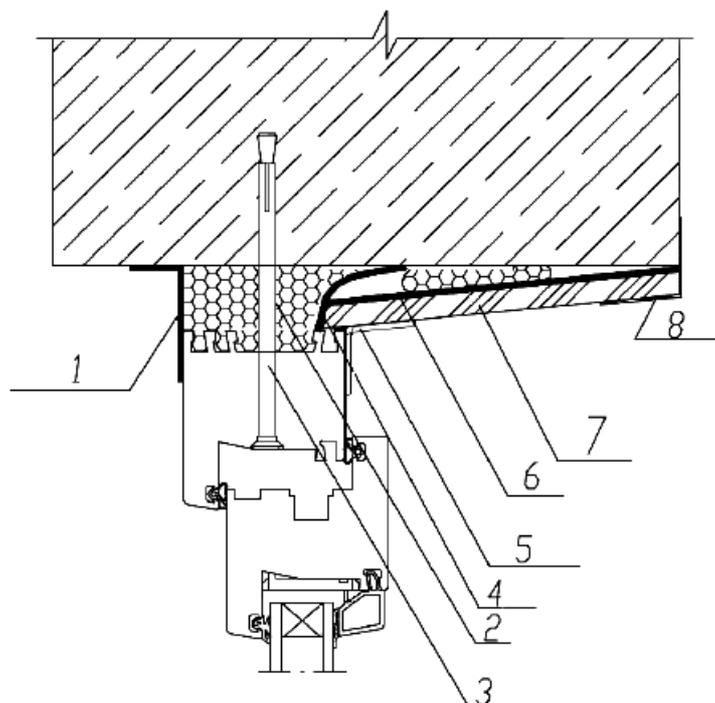
1 - паропроницаемый герметик; 2 - пенный утеплитель; 3 - рамный дюбель; 4 - паронепроницаемый герметик или пароизоляционная лента; 5 - уголок из ПВХ; 6 - полиэтиленовая пленка; 7 - гипсокартонный лист с окраской; 8 - уголок из ПВХ
