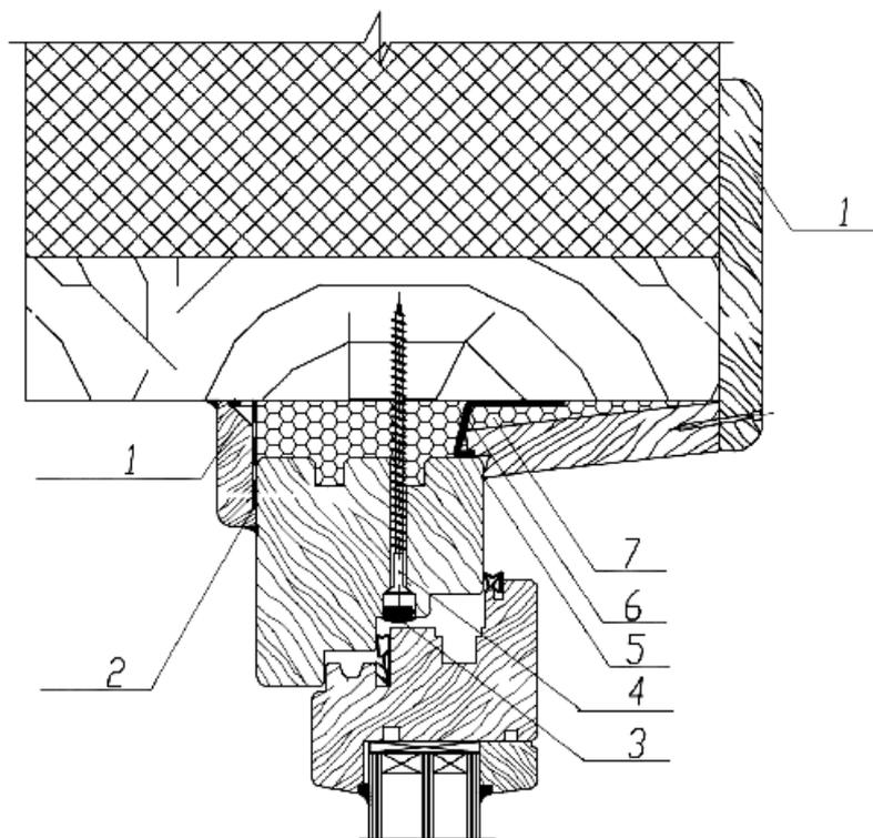
1 - нащельник; 2 - паропроницаемый герметик; 3 - декоративная заглушка; 4 - строительный шуруп; 5 - силиконовый герметик; 6 - пароизоляционный герметик; 7 - пенный утеплитель
