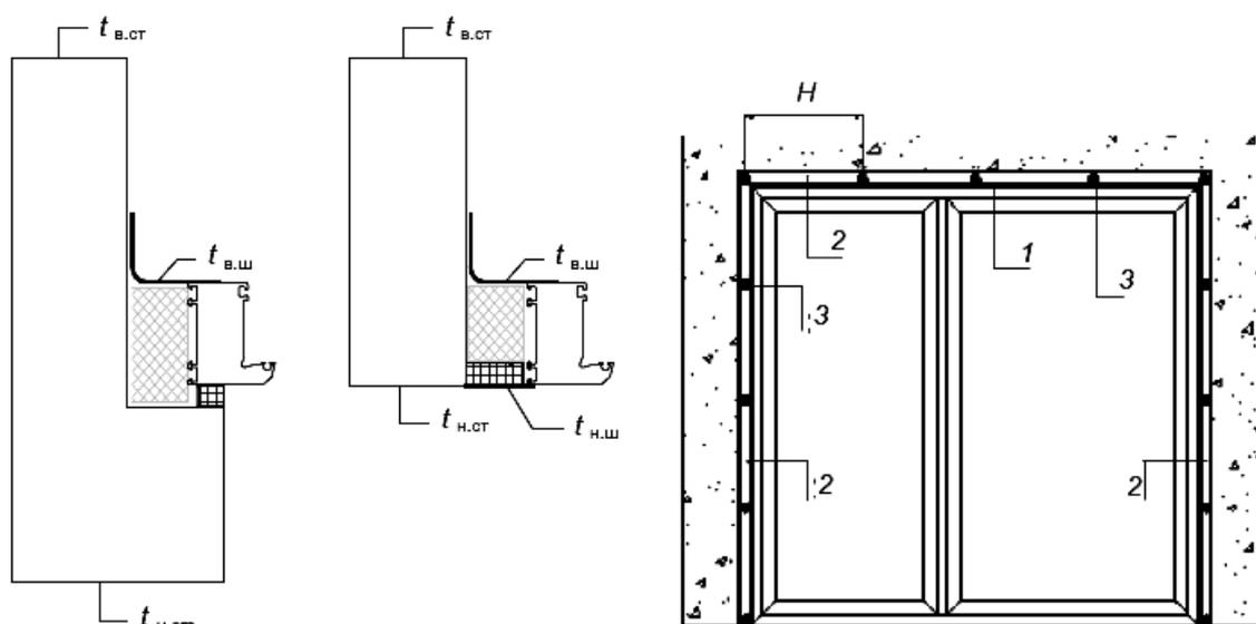
1 - габаритный контур оконного блока; 2 - монтажный шов; 3 - контрольные точки по периметру
