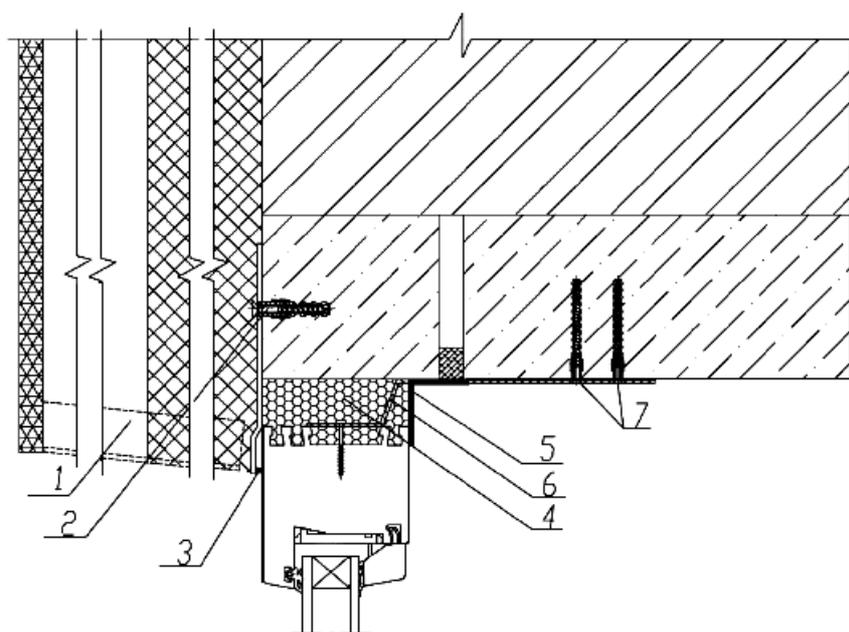
1 - вентилируемый фасад (показан условно); 2 - анкер Ф6х60 (шаг крепления - 500 мм); 3 - паропроницаемый герметик; 4 - пенный утеплитель; 5 - паронепроницаемый герметик; 6 -
