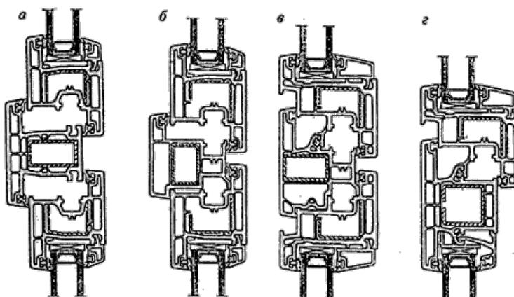
*а* - импостный притвор оконной системы с наружным и внутренним уплотнениями; *б* - штульповой (безимпостный) притвор оконной системы с наружным и внутренним уплотнениями; *в* - штульповой (безимпостный) притвор оконной системы со средним и внутренним уплотнениями; *г* - импостный притвор неоткрывающихся и открывающихся элементов оконной системы со средним и внутренним уплотнениями
