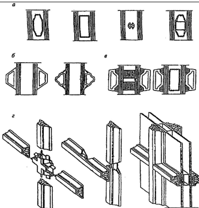
*а* - профили внутренней рамки стеклопакета; *б* - накладные декоративные раскладки; *в* - вариант комбинированного применения накладных раскладок и внутренней рамки стеклопакета; *г* - переплетные соединения раскладок
