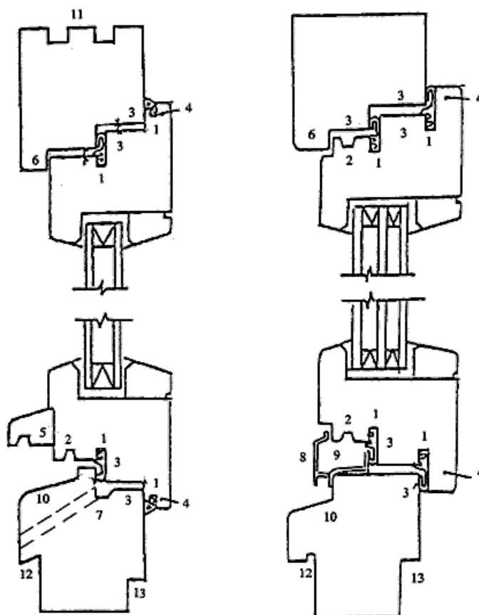
1 - паз под уплотняющую прокладку; 2 - водоотводная канавка; 3 - притворная часть; 4 - наплав створки; 5 - отлив; 6 - наплав коробки; 7 - водоотводной желоб; 8 - дождезащитный профиль; 9 - водоотводная камера; 10 - уклон для отвода воды; 11 - пазы под соединительные шпонки; 12 - четверть под слив; 13 - четверть под подоконную доску
