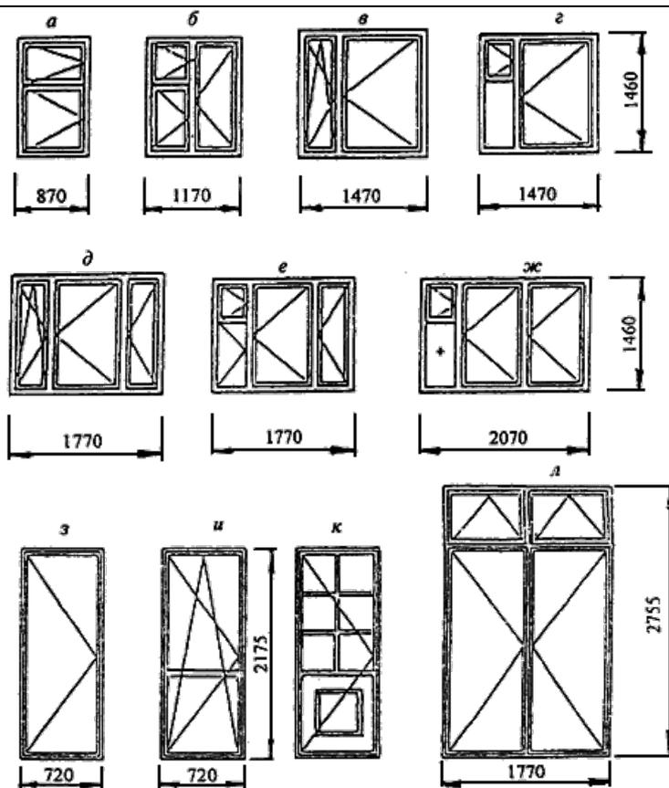
*а, б, в, г, д, е, ж* - примеры конструкций оконных блоков 15М по высоте; *з, и* - конструкция однопольных балконных дверных блоков размером 22-7; *к* - то же, по индивидуальному заказу: с горбыльковым переплетом и глухой филенкой; *л* - примеры конструкции двухпольного балконного дверного блока с двойной фрамугой для общественных зданий размером 28-18
