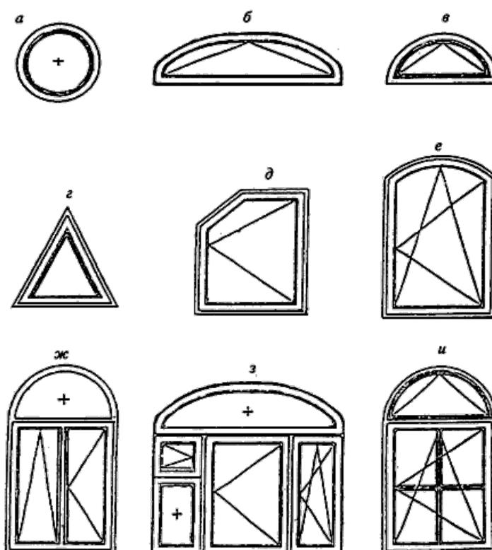
*а* - круглый неоткрывающийся оконный блок; *б* - полуовальный оконный блок с откидным
