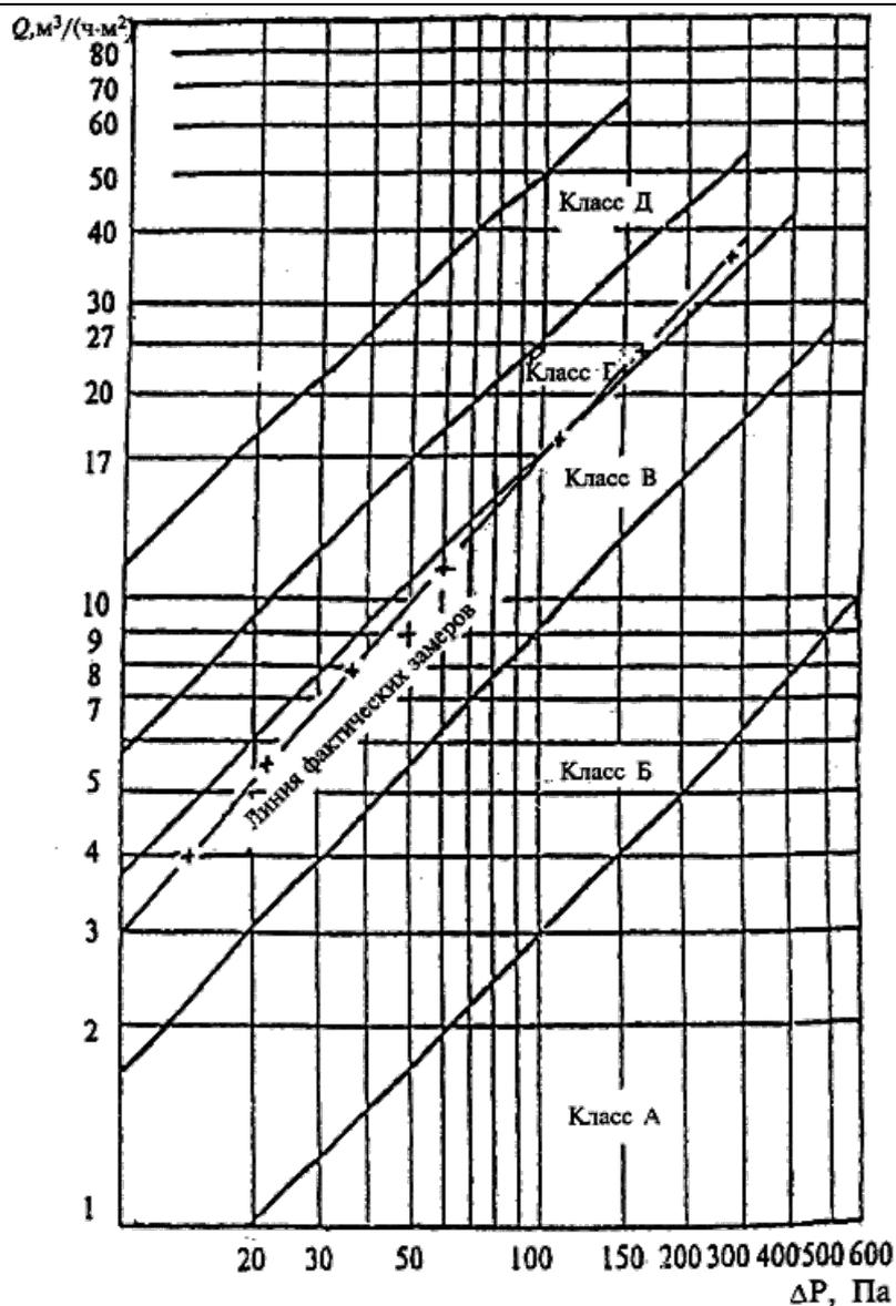
Рисунок Б.1 - Пример определения класса воздухопроницаемости
