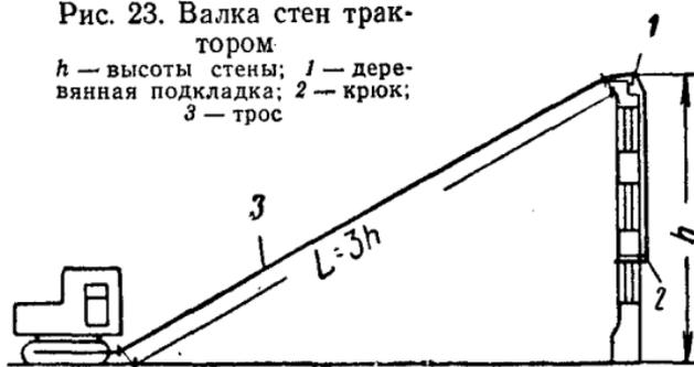
По отношению к простенку, подлежащему валке, трактор должен стоять под прямым углом. Для валки простенка или стены нужны усилия и рывок, способные преодолеть упругость в момент раскачки стены. При малой мощности трактора стены, наклонившись, может вновь возвратиться в вертикальное положение, увлекая за собой трактор. В момент падения стены трактор должен продолжать движение вперед, чтобы избежать возможных осколков от разлета щебенки и вытянуть рабочий трос.
