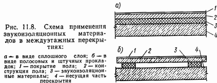
Рис. 11.8. Схема применения звукоизоляционных материалов в междуэтажных перекрытиях:
