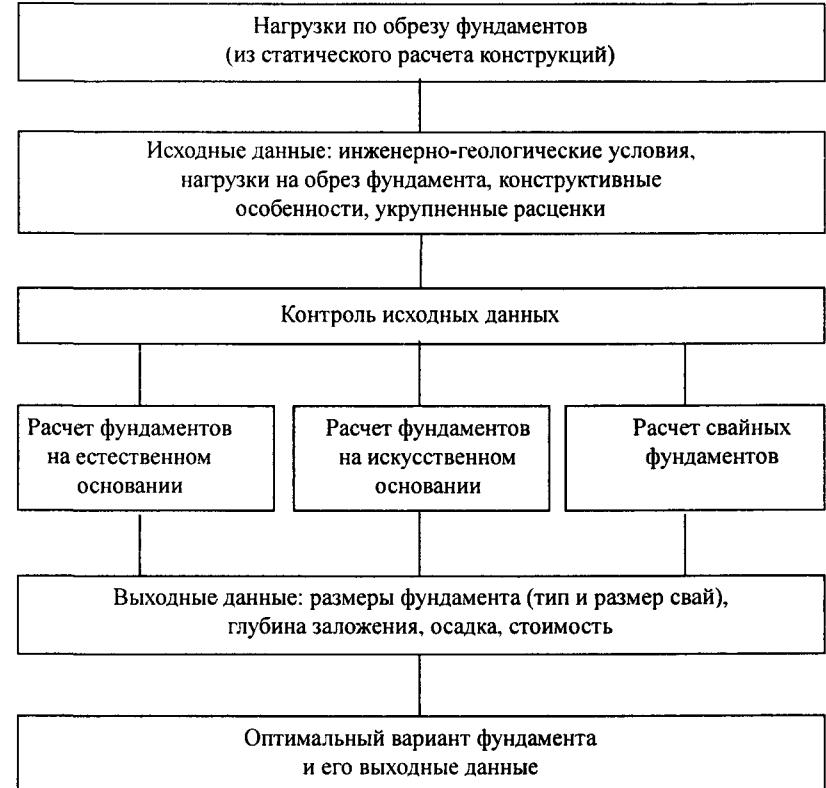
Рис. 14.1. Принципиальная схема комплекса программ многовариантных расчетов фундаментов различных типов
