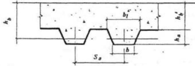
**Рисунок 1 – Поперечное сечение плиты**
