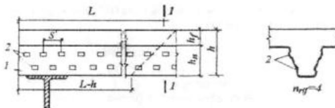
**1-1 - сечение по пролету настила в месте наибольшего изгибающего момента, в четверти пролета, в местах приложения сосредоточенных сил; 1 - стальной профилированный настил; 2 - выштампованные рифы; L - длина участка расположения рифов на стенках настила, учитываемых в расчете его анкеровки по формуле (24)**
