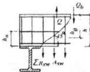
**Рисунок 12 - схема усилия в наклонном сечении плиты при расчете его прочности на действие поперечной силы**
