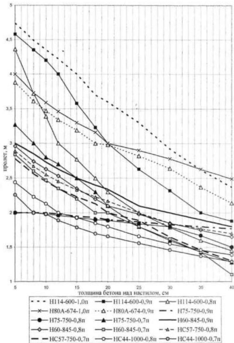
**Рисунок 5 - Зависимость максимального пролета настила от толщины свежеуложенного бетона над настилом при его неразрезной двухпролетной схеме**
