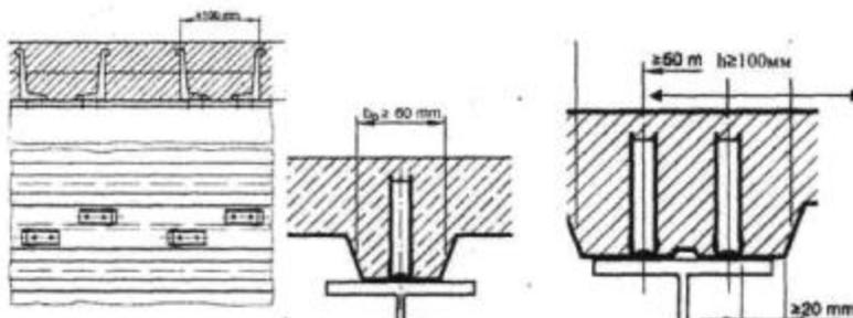
**Рисунок 26 – Расположение упоров параллельно оси балки**
