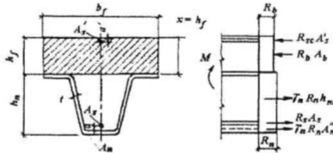
**Рисунок 11 – Схема усилий в пролетном сечении при расположении нейтральной оси на уровне верхней полки профилированного настила**
