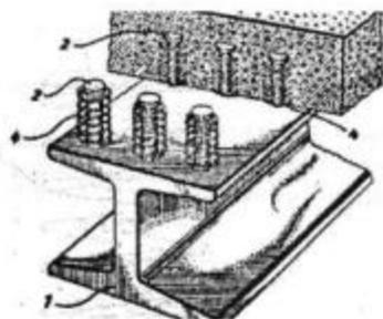
1 – стальная балка перекрытия; 2 – стад-болт; 3 – бетон; 4 – стальная пружина.
