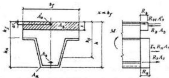
**Рисунок 9 - Схема усилий в пролетном сечении плиты при расположении нейтральной оси в пределах толщины полки плиты**
