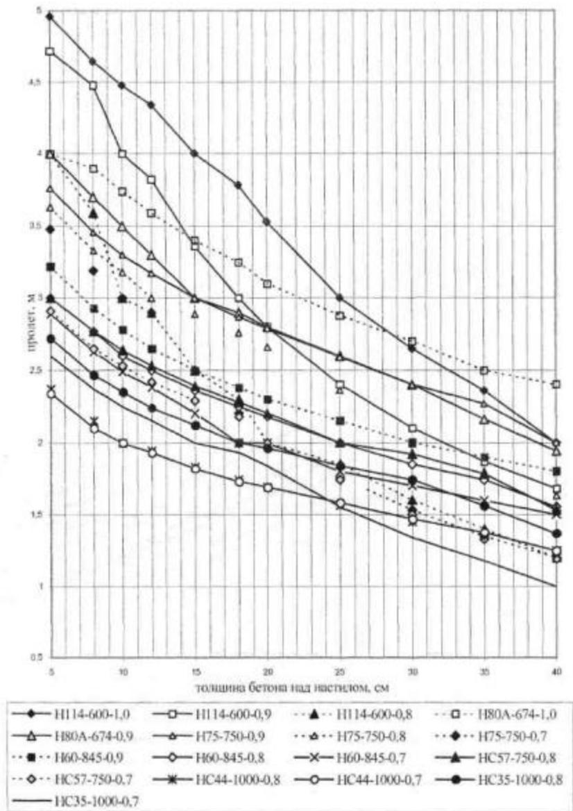
**Рисунок 4 - Зависимость максимального пролета настила от толщины свежеуложенного бетона над настилом при его неразрезной двухпролетной схеме**
