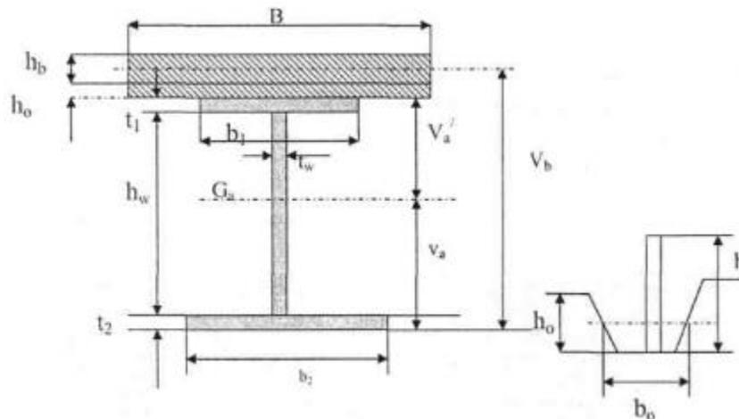
Рисунок 18 – К расчету комбинированной балки
