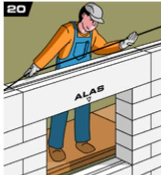
20. Зона над оконными и дверными проемами требует армирования. Установка готовых газобетонных перемычек позволяет избежать организации дополнительной теплоизоляции.
