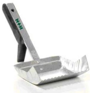
**Кельмы (ковши)** применяются для нанесения клеевого раствора толщиной 1-3 мм на вертикальные и горизонтальные поверхности блоков Н+Н, а также выполнения кладки при строительстве стен сложной конфигурации. Ширина кельмы должна соответствовать ширине газобетонного блока Н+Н. Благодаря этому раствор наносится равномерно по всей поверхности блока и не стекает по бокам.
