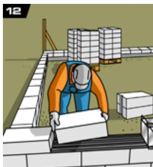
12. К кладке второго ряда можно приступать после схватывания раствора первого ряда (т.е. через 1-2 часа). Кладка начинается с угла, с перевязкой блоков, смещение рядов должно быть не менее 10 см. Клей не наносится на торцы блоков. Блоки устанавливаются и выравниваются по месту, см. выше п.7.
